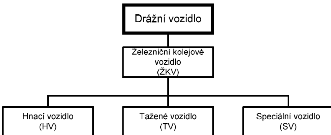
Obrázek 1 - Rozdělení ŽKV dle ČSN 280001
