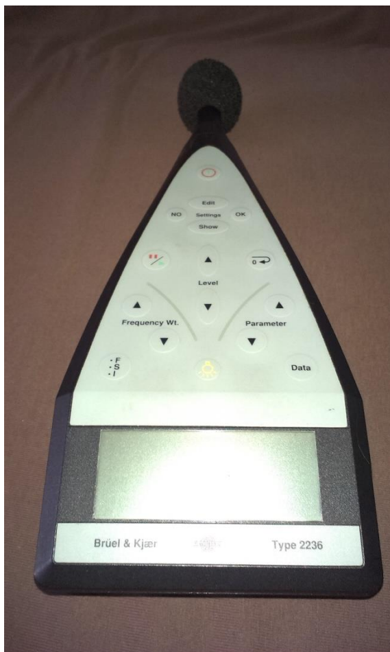
Obrázek 23 - Zvukoměr 2236 Brüel & Kjaer
