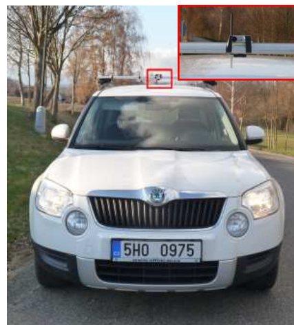
Obr. č. 29 – Umístění kamery na příčnku
