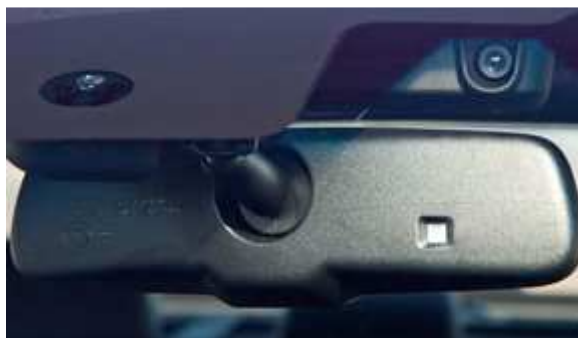
Obr. č. 3 – Umístění kamery v LDW [33]
