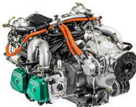
Obrázek 6 Motor 912 ULS, zdroj: [17]
