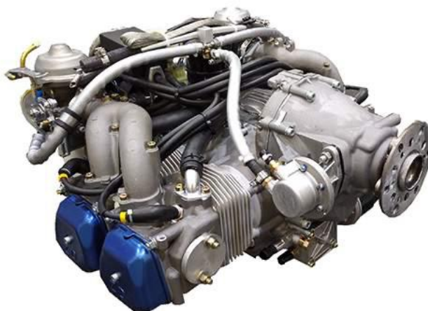
Obrázek 10 Motor Zonsen CA500, zdroj [16]
