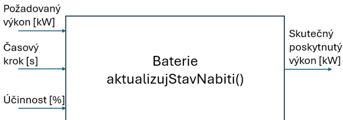
Obrázek 18 - Blokové schéma třídy Baterie
