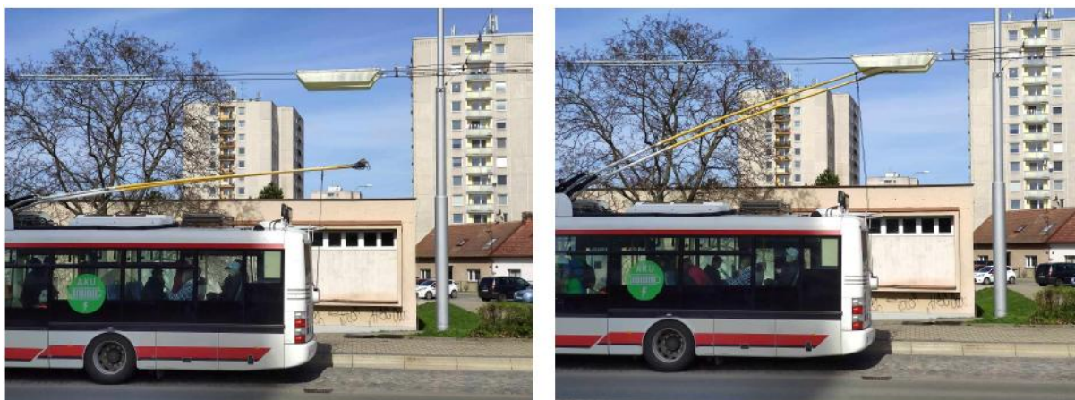
Obrázek 4 – Navádění sběračů při jejich zvedání pomocí stříšek [12]
