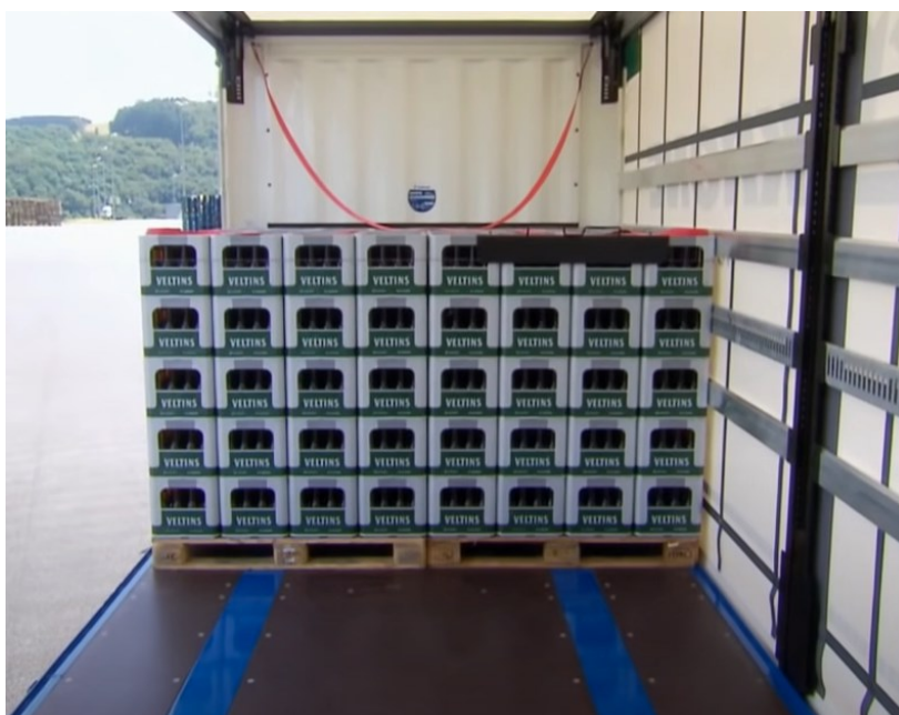
Obrázek 8 Kompaktní způsob uložení nákladu
