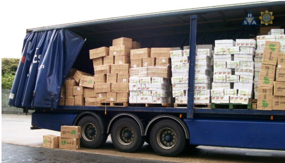
Obrázek 10 Příklad špatné fixace nákladu
