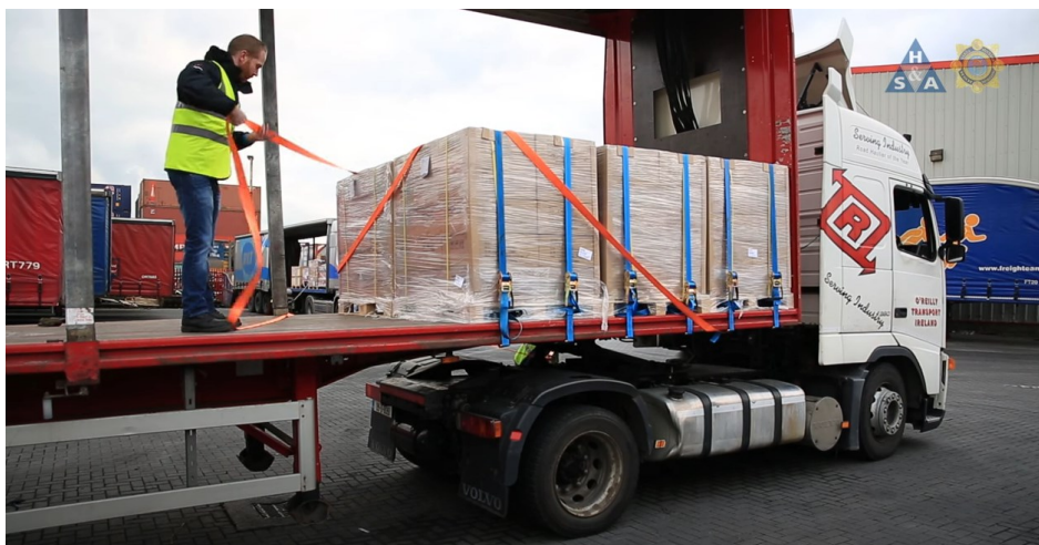
Obrázek 11 Správné blokování nákladu
