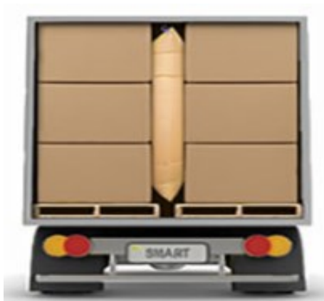
Obrázek 9 Kompaktní způsob uložení nákladu s použitím vyplňovacích prostředků
