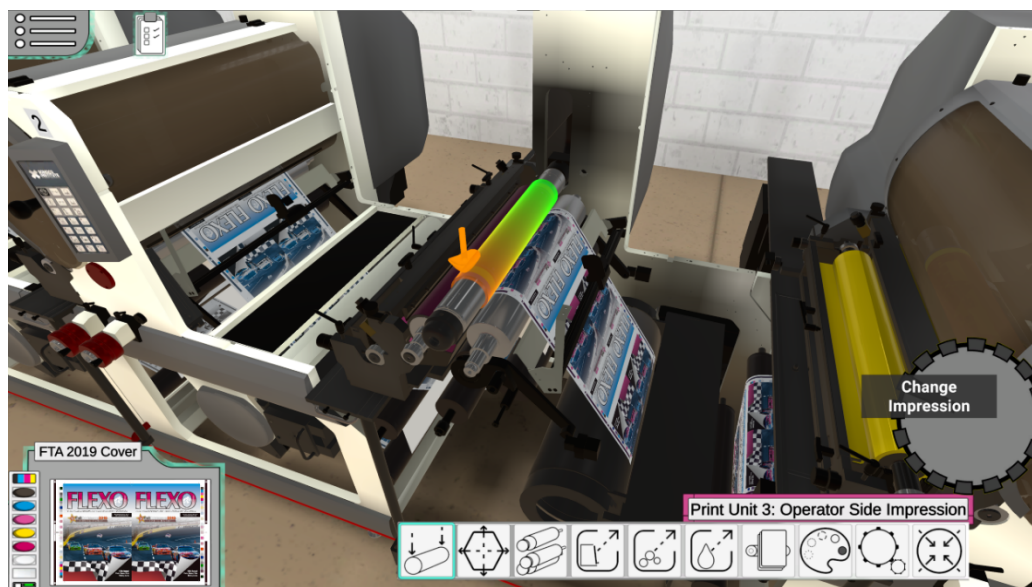
Obrázek 9 – Simulace flexotiskového stroje s vyznačeným aniloxovým válcem, adaptováno z [87]
