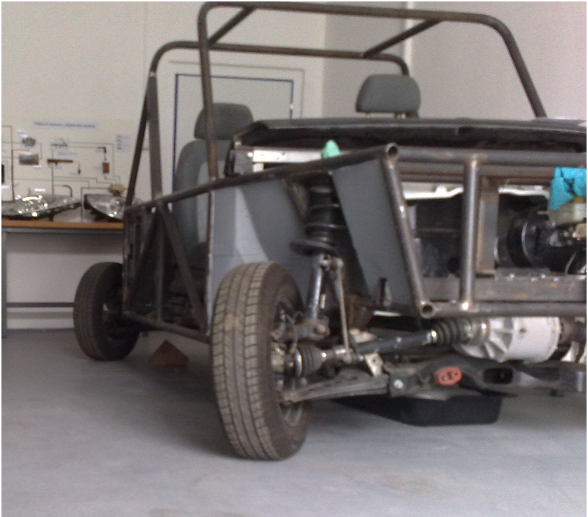
Obrázek 11: Souhlasné natáčení kol experimentálního vozidla
