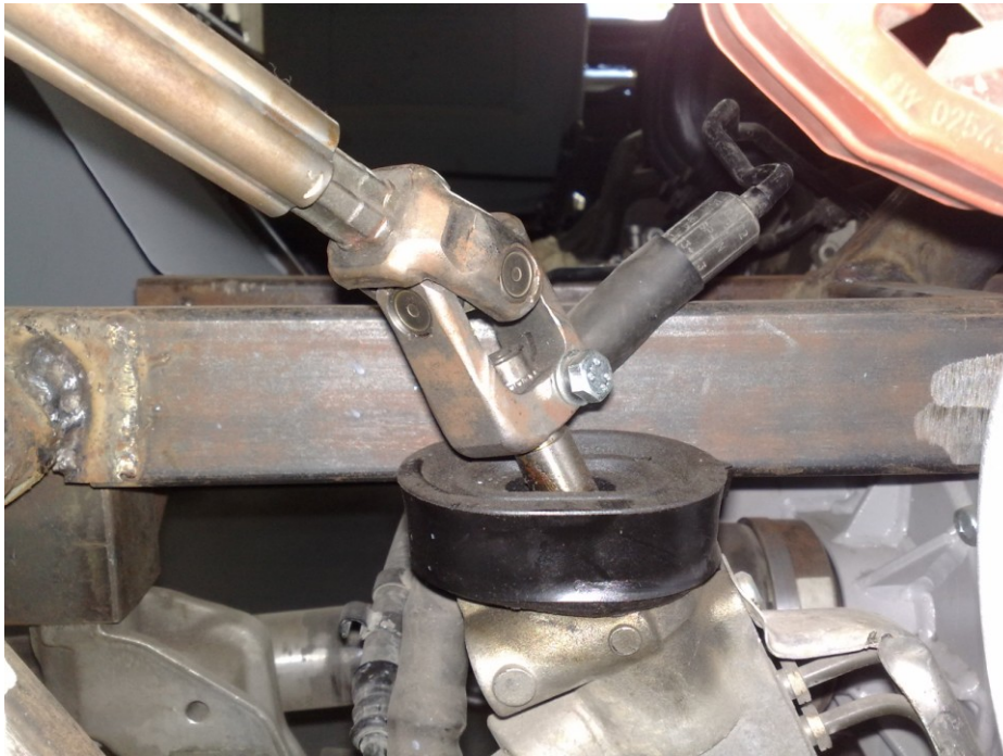
Obrázek 15: Zadní převodka řízení experimentálního vozidla
