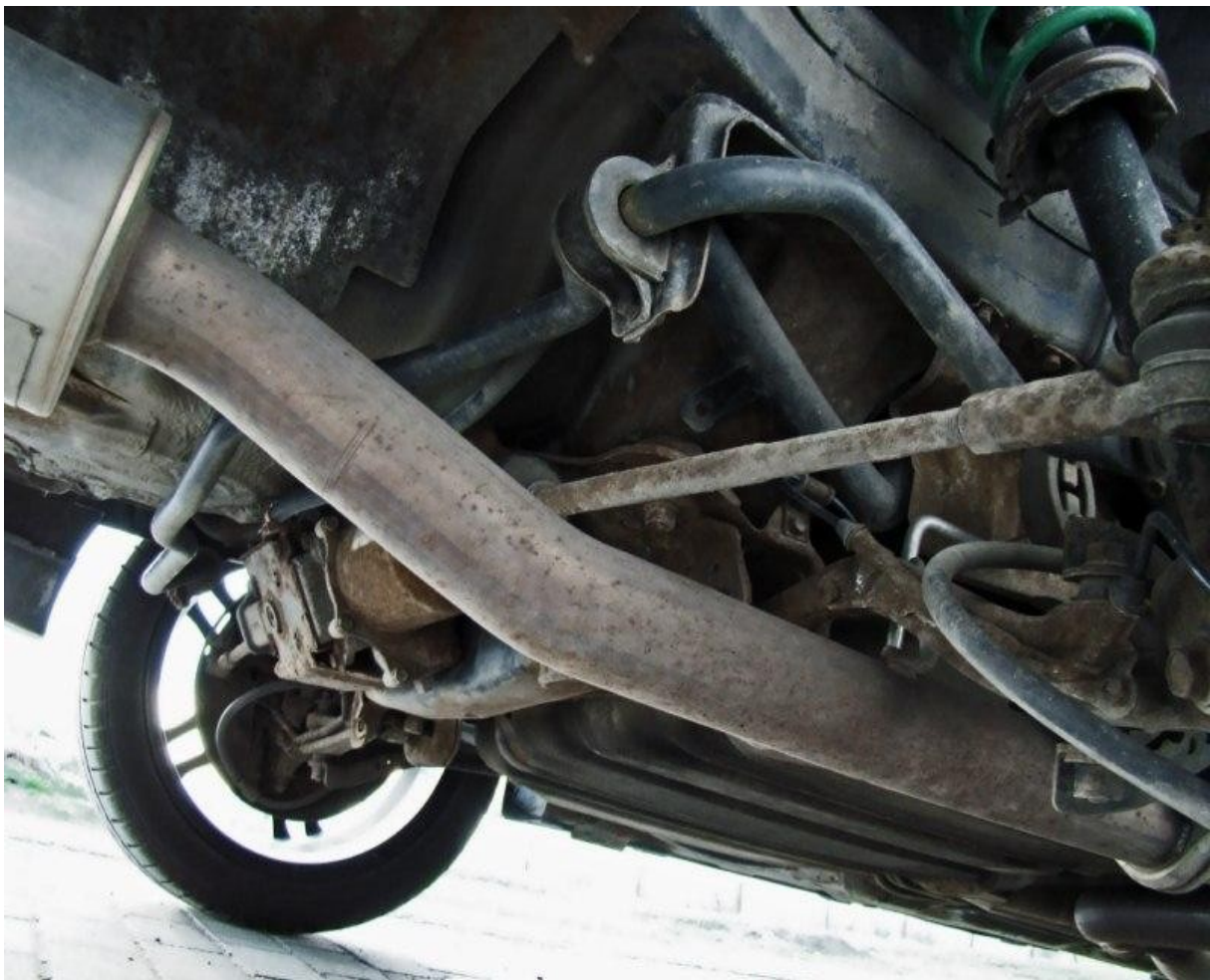
Obrázek 4: Říditelná zadní náprava Honda Prelude 4WS
