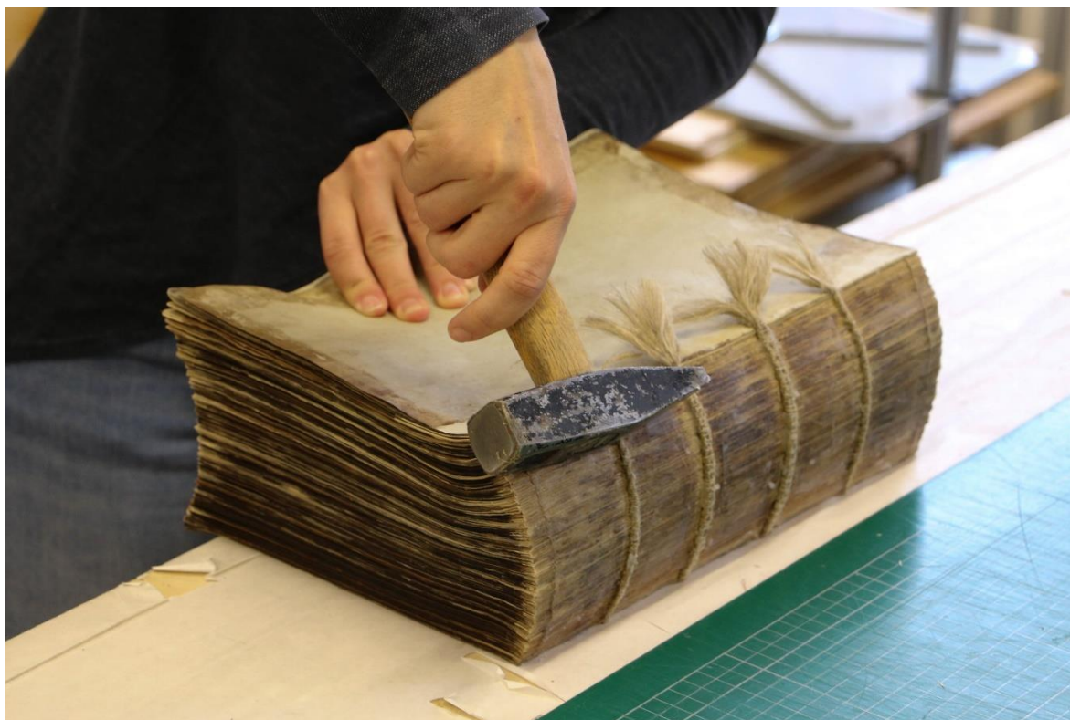
Obr. 72: Zaoblění hřbetu knižního bloku
