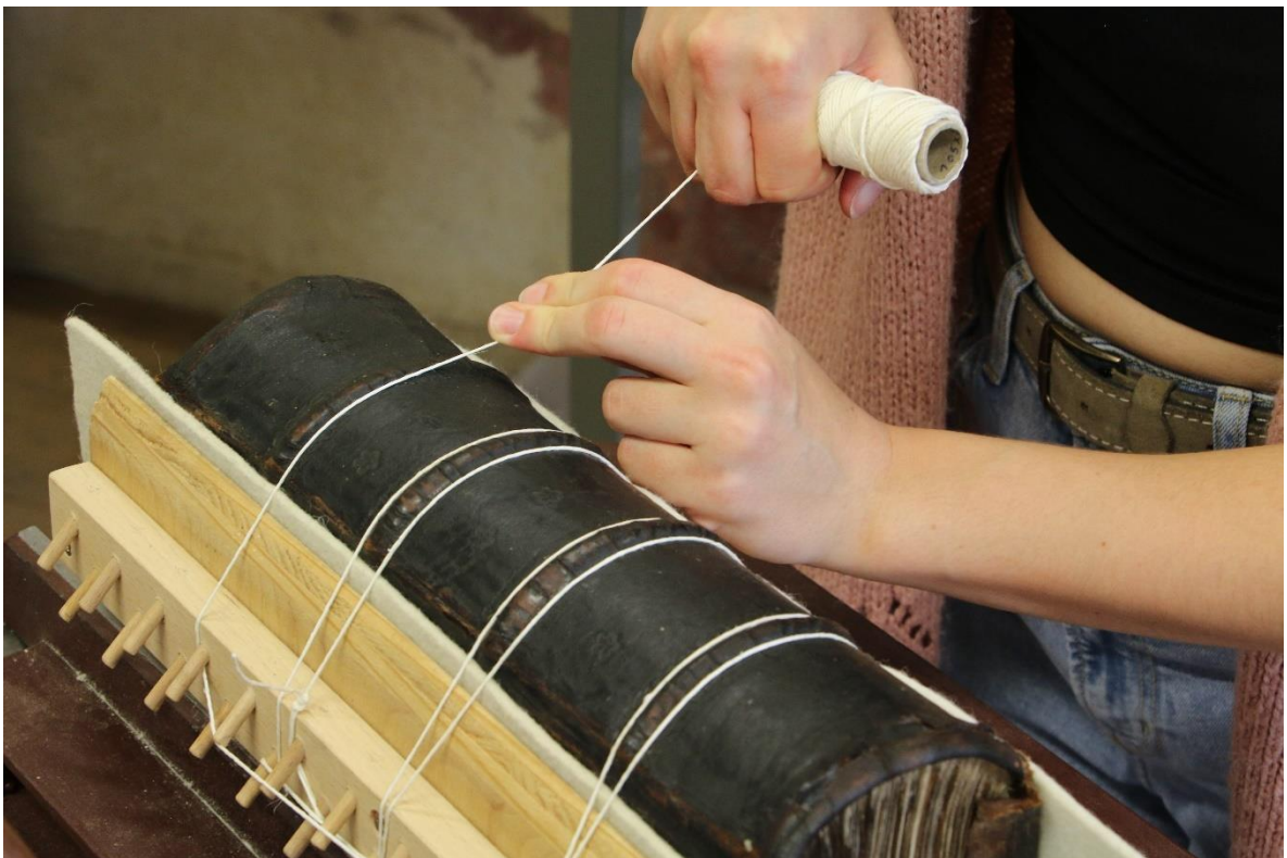
Obr. 93: Vyvázání hřbetu knižní vazby
