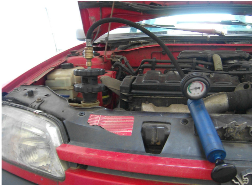
Obr. 4.1 – Zkouška těsnosti soustavy
