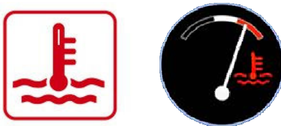
Obr. 2.9 – Varovná kontrolka chlazení a teploměr s integrovanou kontrolkou [9]
