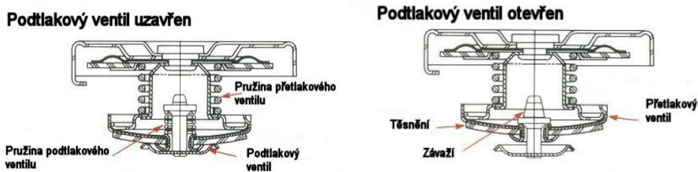
Obr. 4.2 – Podtlakový ventil v otevřené a zavřené poloze [15]
