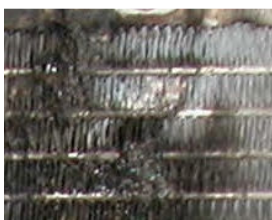
Obr. 3.1 – mechanicky poškozený chladič
