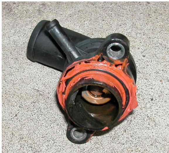
Obr. 3.2 – Na obrázku je zachycen nesprávný termostat použitý při výměně
