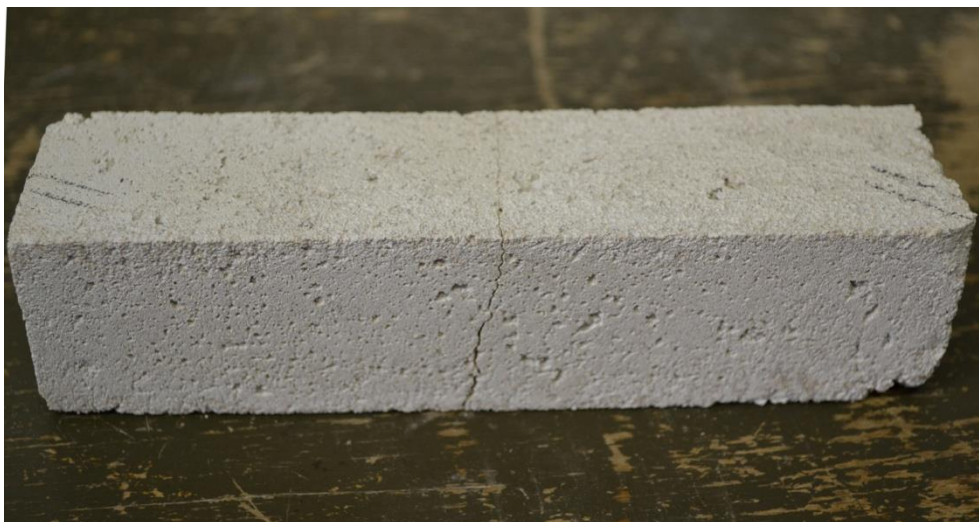
Obr. 3. 2 Připravený vzorek s vytvořenou prasklinou
