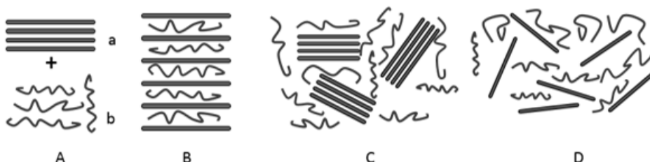
Obrázek 8 - Typy nanokompozitů, které mohou vzniknout kombinací (a) vrstevnatého plniva a (b) polymerních makromolekul: Interkalovaný kompozit (B), nano/mikro kompozit (C), exfoliovaný nanokompozit (D)
