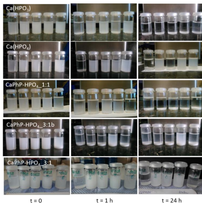
Obrázek 44 - Ilustrace průběhu lékovkového testu rozpouštědel pro směsné materiály. Pořadí rozpouštědel zleva doprava: destilovaná voda, IPA, ethanol, butanol, aceton.
