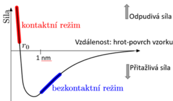
Obrázek 14: Grafické znázornění závislosti výsledných meziatomových sil na vzdálenosti mezi hrotem a vzorkem, převzato a upraveno z [74].
