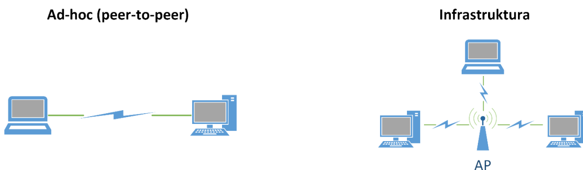
Obrázek 1 Topologie WLAN
