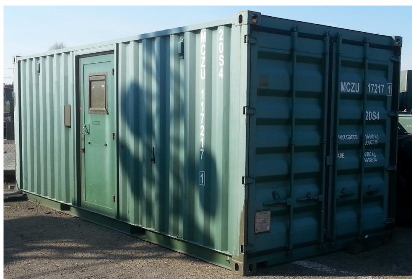
Obrázek 3 - Kontejner ISO 1C – Převážná nádrž pitné vody
