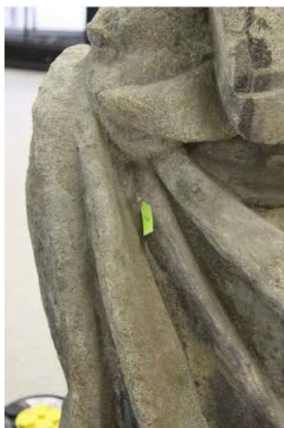
Obr. 27 Místo odběru vzorku 6942 (T2). Tmel, drapérie na zádech pod toulcem.
