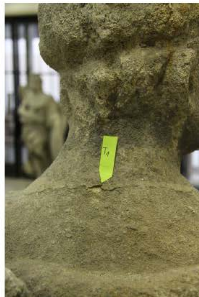
Obr. 26 Místo odběru vzorku 6941 (T1), tmel na zadní straně krku.
