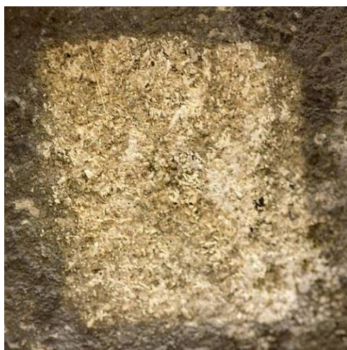
Obr. 13 Zkouška čištění laserem
