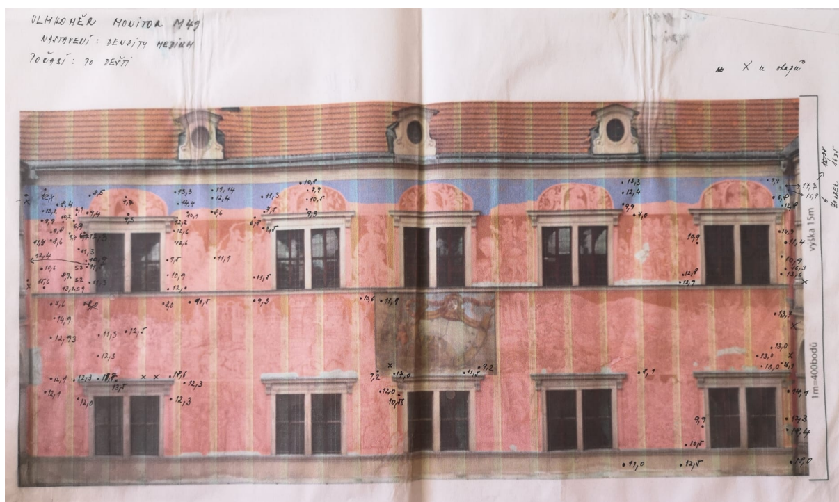
Obr. 16 Polní plán s naměřenými hodnotami vlhkosti. Měření provedeno vlhkoměrem Monitor M49.
