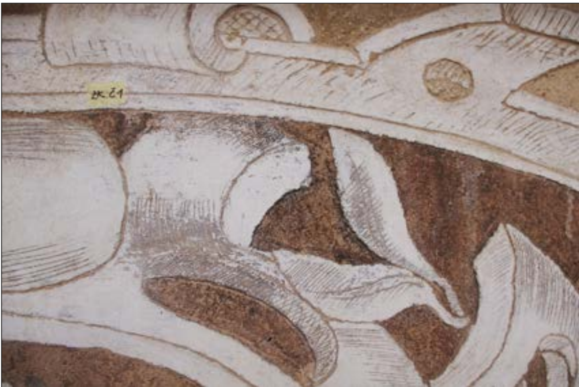
Zkouška ČV1 po vyschnutí. Pomocí základního očištění vodou s pomocí jemných kartáčků a houbiček, lze revidovat povrchové nečistoty (prach, ptačí exkrementy) a nesoudržné druhotné zásahy (zpráškovatělé okrové retuše přeškráblých ploch). Červené a černé barevné vrstvy přeškráblých pozadí renesančních omítek nelze tímto způsobem čistit.
