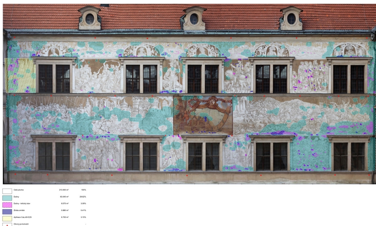
Obr. 15 Grafický zakres dutin ve sgrafitech na fasádě (Zákes z roku 2012) 32
