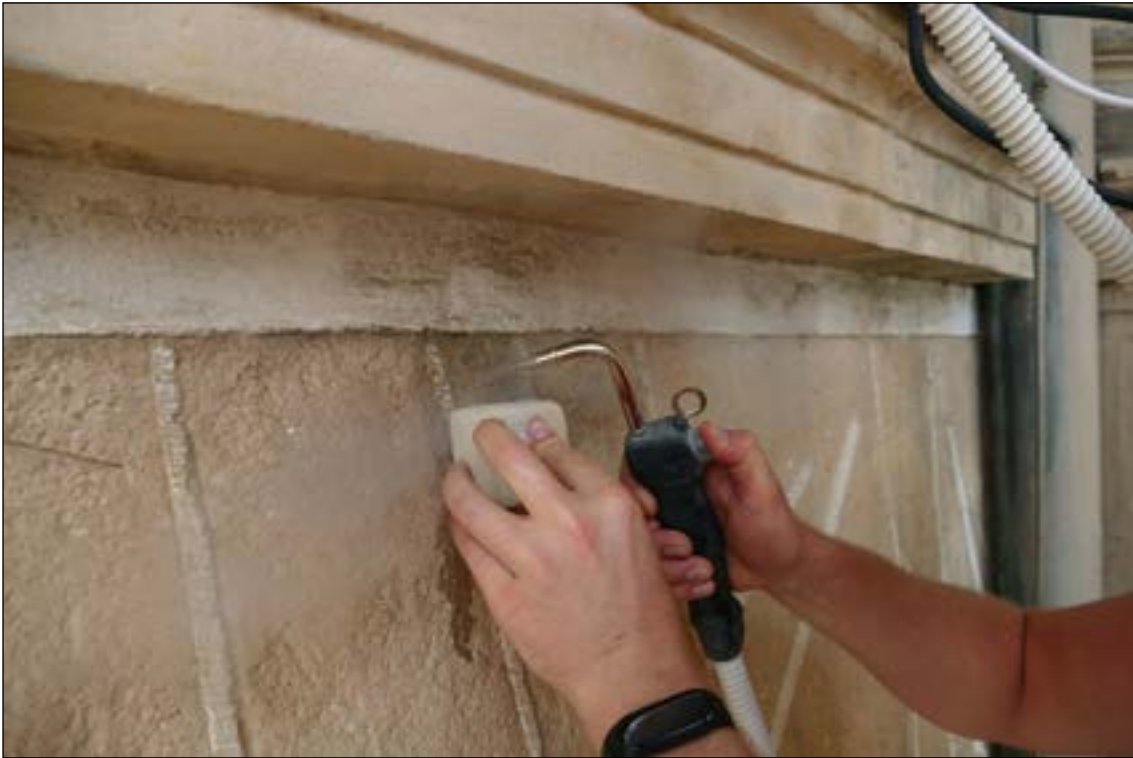
Zkoušky čištění se zaměřily na plochy přeškráblé i plochy s bílým nátěrem. Zkouška čištění párou s pomocí houbičky na renesančních omítkách.
