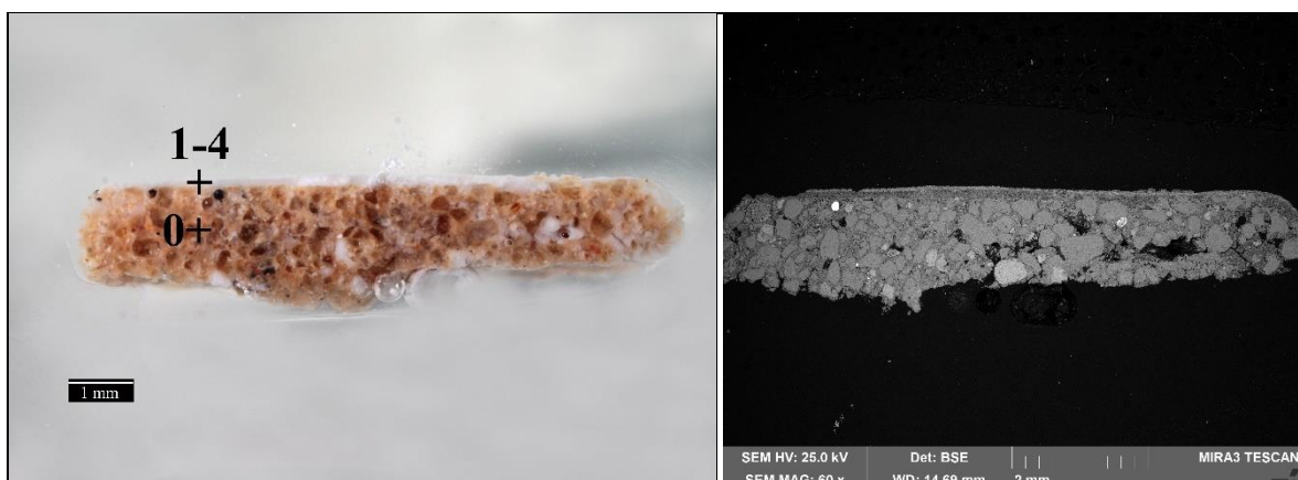
Obr. 39, 40 Mikrosnímky nábrusu v menším zvětšení, optická a skenovací elektronová mikroskopie.
