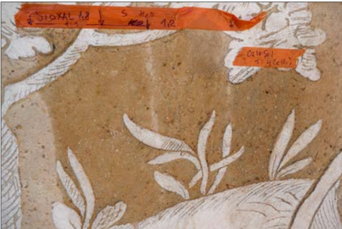
Zkouška K11 - SioXal 8 - ředěný vodou 1:1 (75g/l) - zkouška na raně barokní omítce Zkouška K12 - SioXal 8 - ředěný vodou 1:2 (50g/l) Zkouška K13 - CaloSil 25 - ředěný 1:4 s ethanolem. Ředění minimalizuje tvorbu bílého zákalu. Zároveň však oslabuje zpevňovací efekt. Pro zpevnění je nutné aplikaci opakovat.
