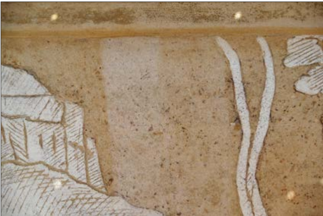
Zkoušky konsolidace na raně barokní omítce po 30ti dnech: Zkouška K5 - CaloSil 25 - koncentrát Zkouška K6 - CaloSil 50 - koncentrát Po vyprchání rozpouštědla tvoří bílý zákal na přeškráblé omítce.
