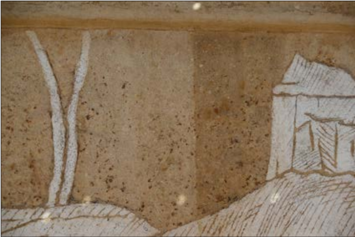
Zkoušky konsolidace na raně barokní omítce po 30ti dnech: Zkouška K1 - KSE 100, K2 - KSE 300, K3 - SioXal A10 - ztmavlé, K4 - SioXal A8 - ztmavlé
