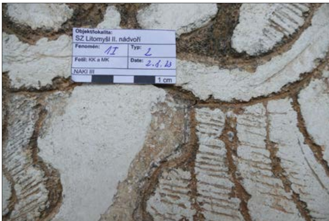
Barevná úprava na bílém nátěru 1I. Závěrečné původní pojednání povrchu barevnou vrstvou nebylo přesvědčivě prokázáno. Na nejlépe dochovaných částech portrétů vojevůdců se zdají být fragmenty okrové barevné vrstvy (na helmicích), která by mohla být původní (1I/2).
