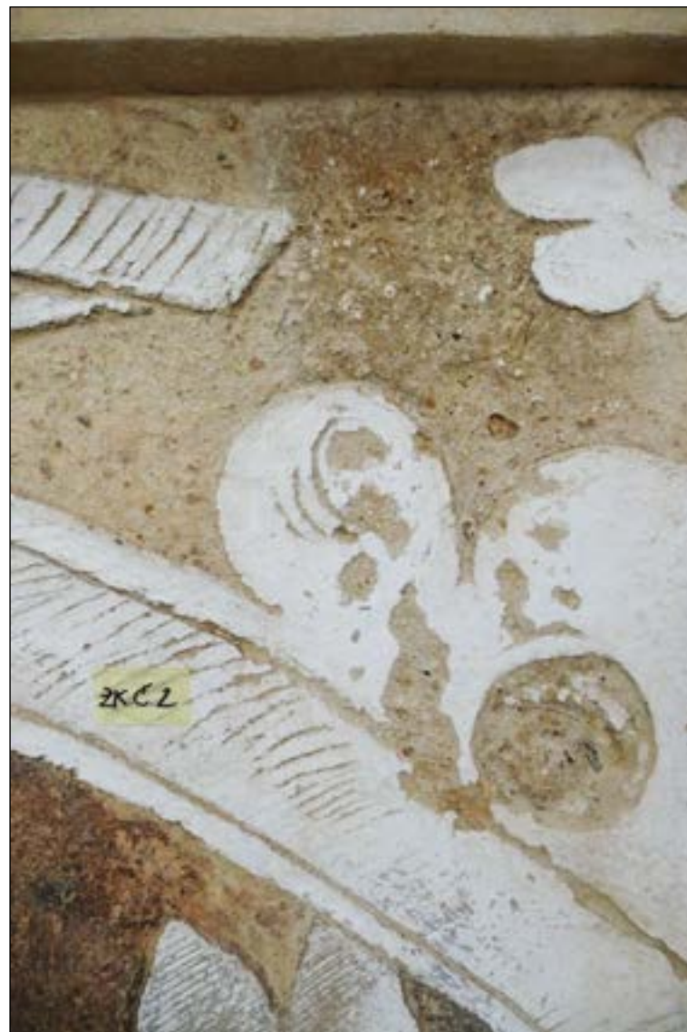
Zkouška ČV2 po vyschnutí.. Pomocí základního očištění vodou s pomocí jemných kartáčků a houbiček, lze revidovat povrchové nečistoty a nesoudržné druhotné zásahy (zpráškovatělé okrové retuše přeškrábělých ploch) a nesoudržné krakely vápenného nátěru z 80. let..
