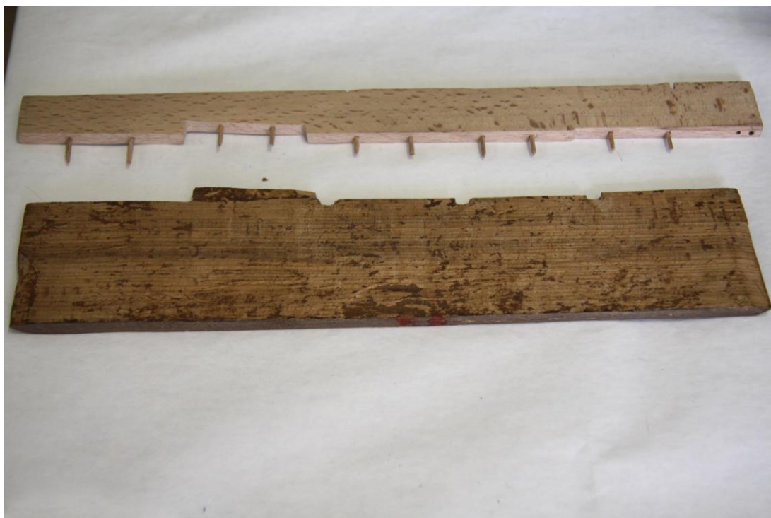
Obr. č. 69: Urbář z r. 1625, vyspravení přední desky, aplikace nové bukové desky, spojení doplňku kolíčky
