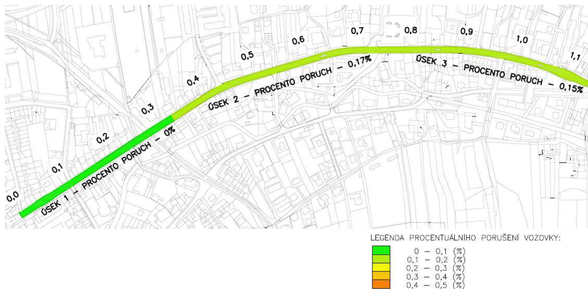
Obrázek 70 – Situace procentuálního porušení vozovky – nový stav
