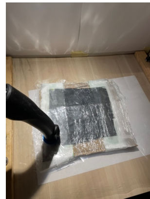
Obrázek 29 výroba vzorků uhlíkového kompozitu - 2
