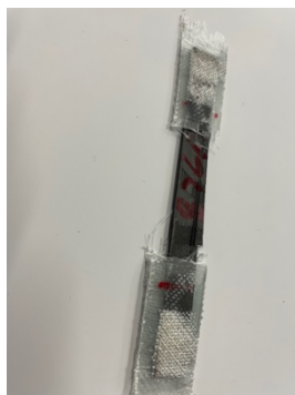
Obrázek 36 vzorek uhlíkové lamely po porušení
