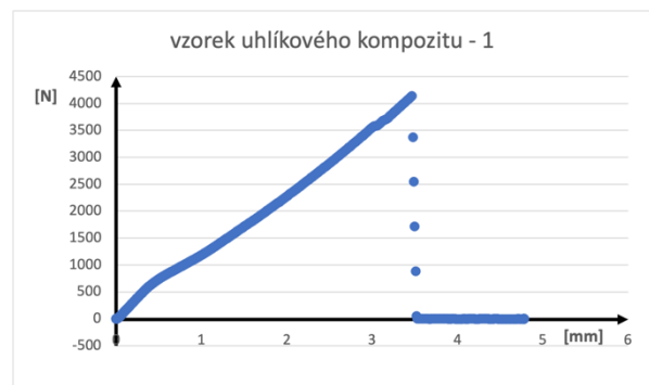
Obrázek 32 graf statické zkoušky uhlíkového kompozitu
