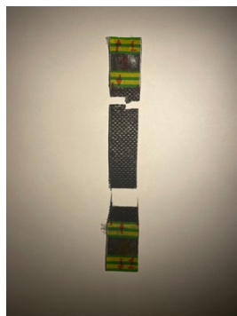
Obrázek 31 porušení vzorku uhlíkového kompozitu
