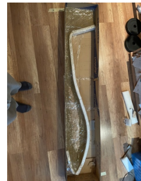
Obrázek 6 vložení separační fólie do formy
