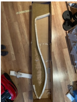
Obrázek 5 příprava formy pro vnitřní laminování
