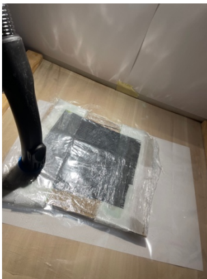
Obrázek 28 výroba vzorků uhlíkového kompozitu
