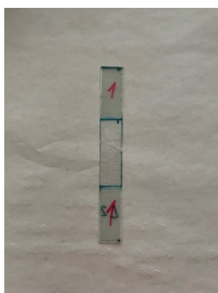
Obrázek 25 vzorek LH500-1 před tahovou zkouškou
