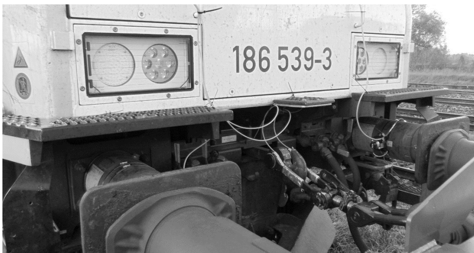
Obr. 3 – měřicí šroubovka na lokomotivě (autor: Ing. Tomáš Michálek, PhD., upraveno)
