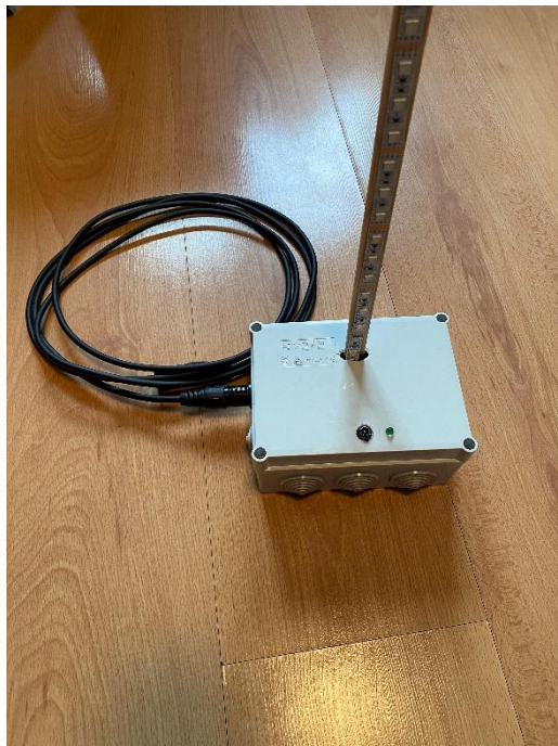
Obr. 28.: Finální konstrukce DMX LED baru
