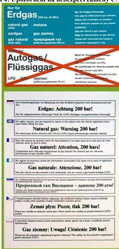
Obrázek 4: Upozornění na nebezpečí záměny CNG a LPG
