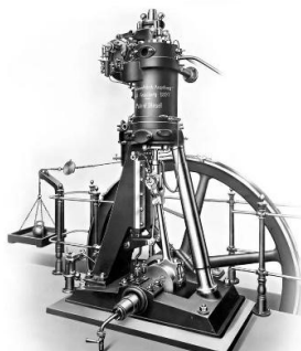
Obrázek 4 První funkční stabilní motor Diesel z roku 1897 (garáž.cz, 2019)
