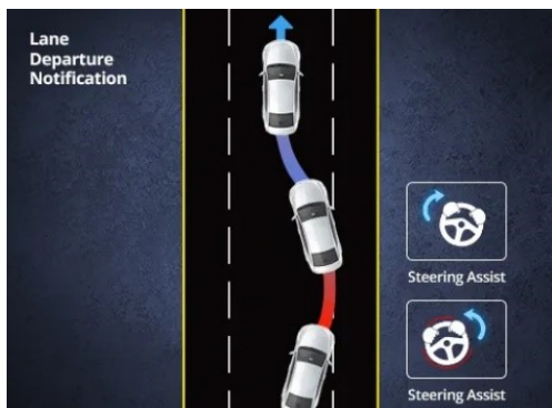
Obrázek 10 Zobrazení funkce systému LKAS (honda-mideast.com, 2022)
