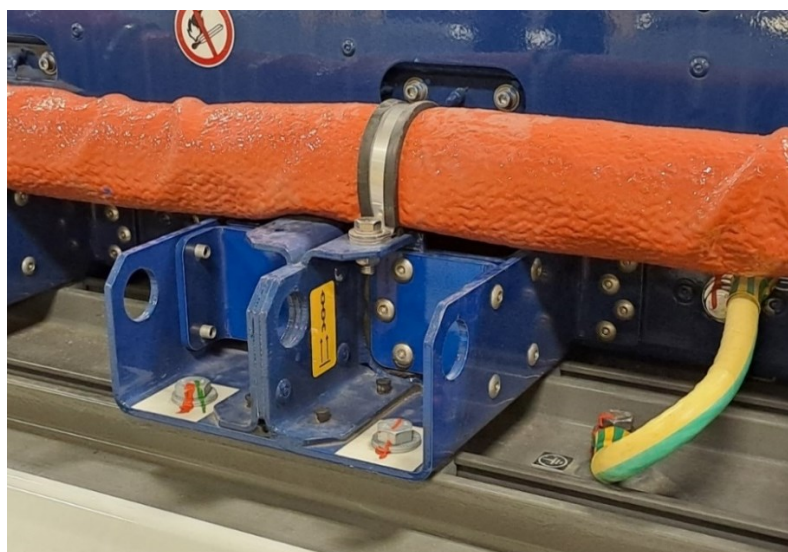
Obr. 5: Detail uchycení pomocí c-drážek
