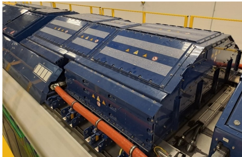
Obr. 3: Trakční bateriová skříň
