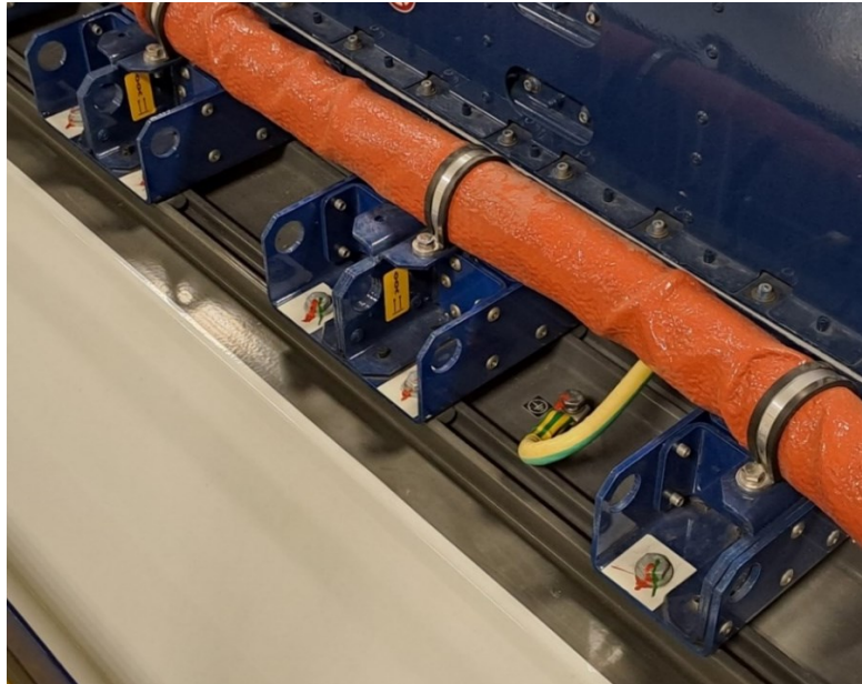
Obr. 6: Detail uchycení trakční bateriové skříně pomocí c-drážek
