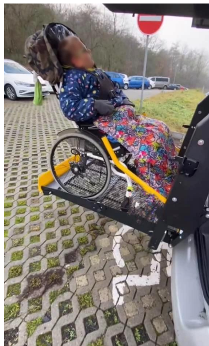
Obr. 20 Hydraulická plošina pro zvednutí vozíku s dítětem do vozidla
