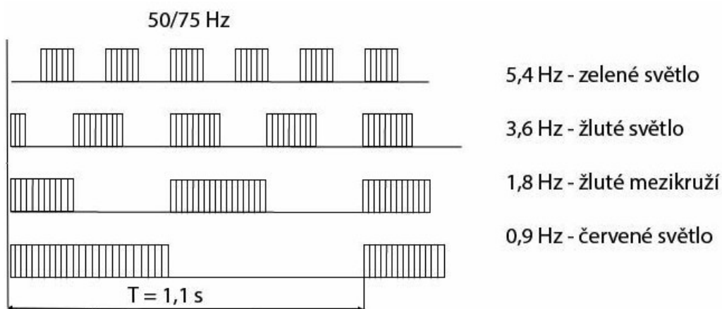
Obrázek 6 - Kódové frekvence vlakového zabezpečovače [1]
