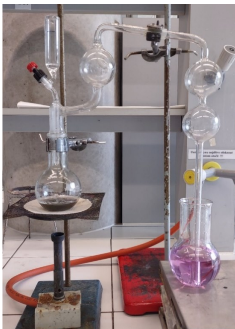
Obrázek 14: Destilační aparatura pro destilaci amoniaku
