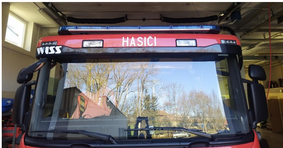
Obrázek 8 Výstražné signalizační zařízení
