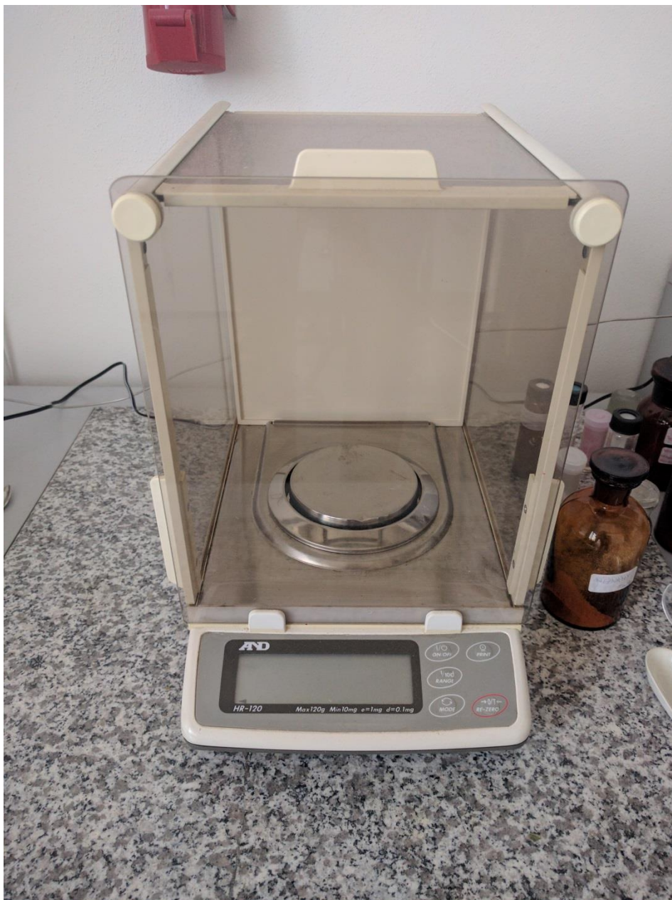
Obrázek 15 – Analytické váhy HR-120-EC
