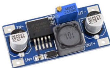
Obrázek 28 Snižující DC-DC měnič 24 V DC / 5 V DC s LM2596 [12]
