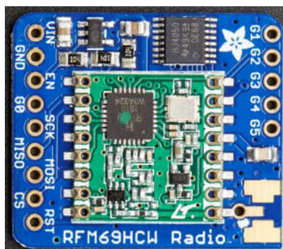
Obrázek 34 Rádiový modul Adafruit RFM69HCW [15]
