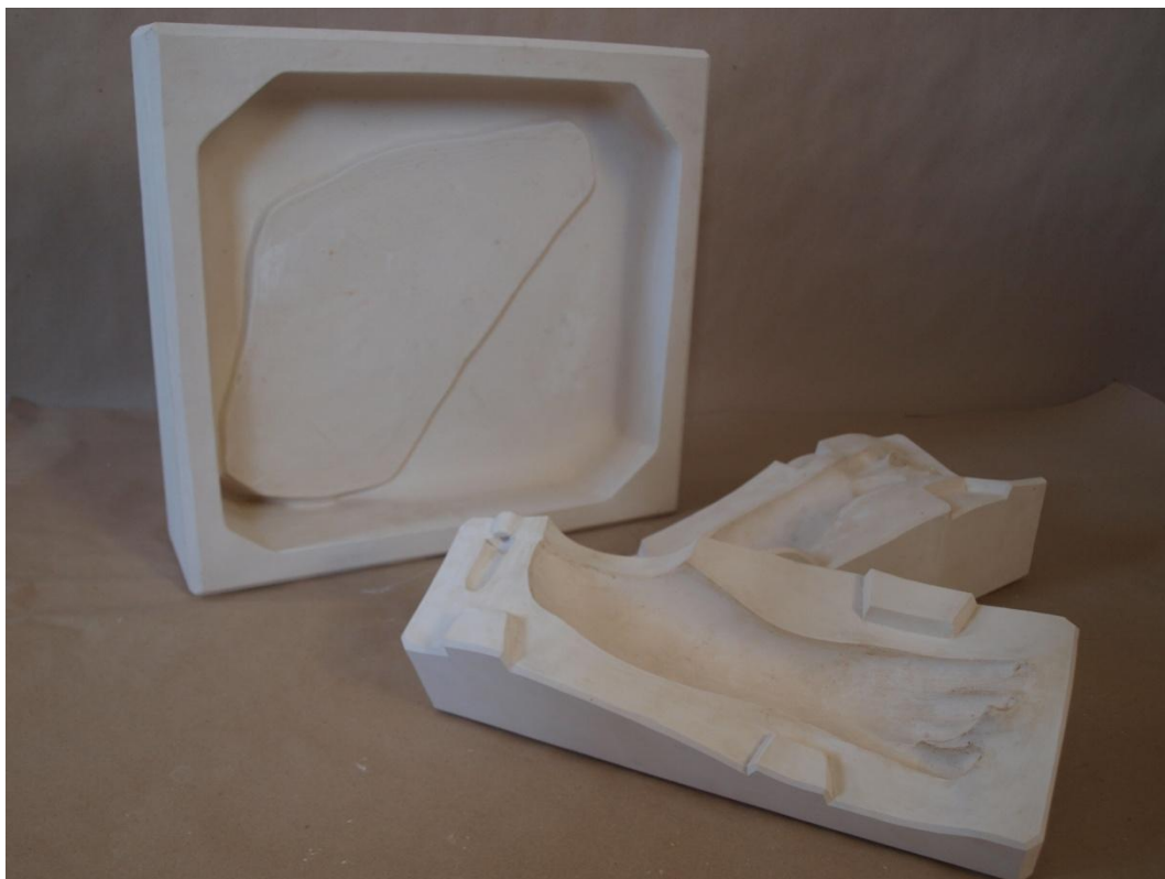
Obrázek 63 – hotové sádrové formy pro výrobu chybějících částí z keramické hlíny
