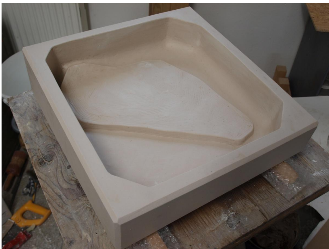
Obrázek 60 – odlitá jednoduchá sádrová forma po stržení hran
