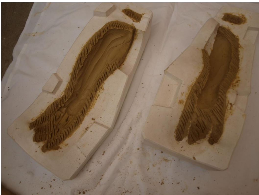
Obrázek 65 – průběh výroby chybějící paže technikou vlačování do formy – před následným spasováním
