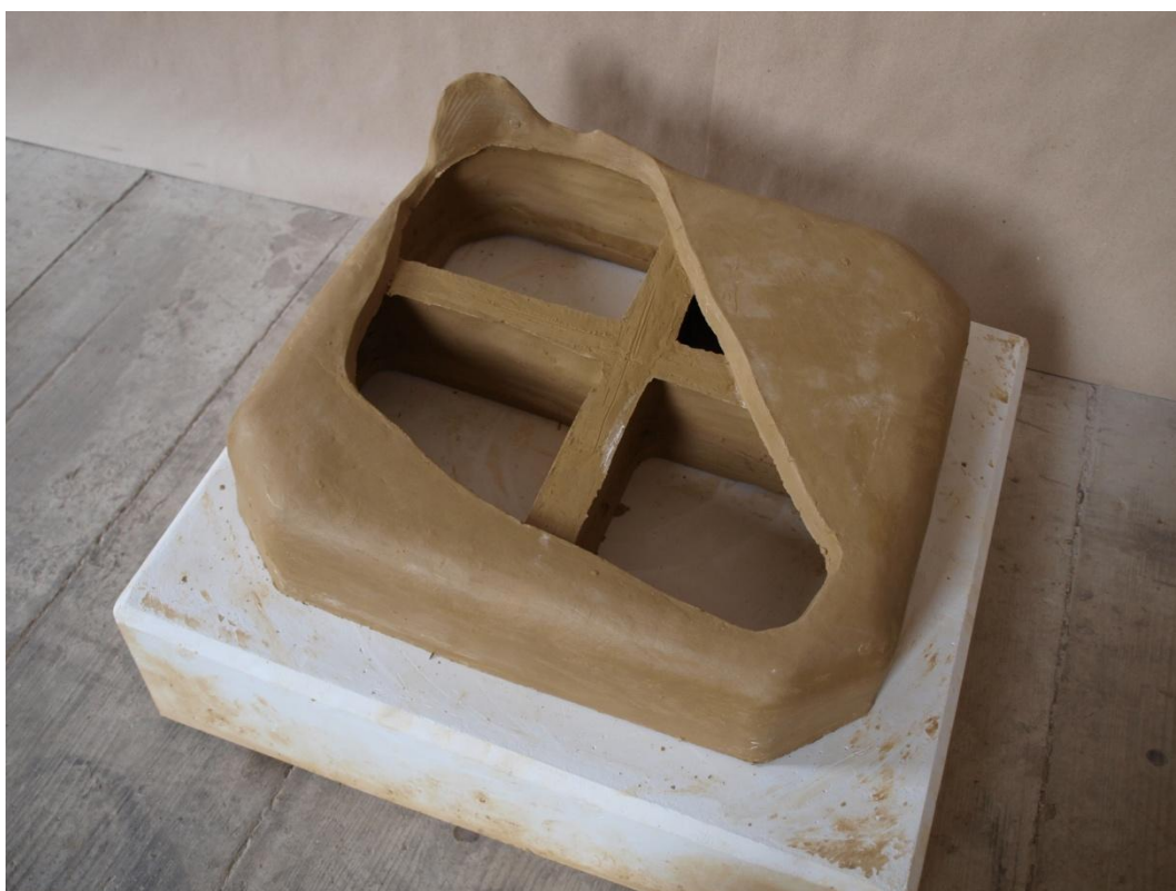
Obrázek 68 – soklík po vyjmutí z formy připravený k sušení a pozdějšímu výpalu
