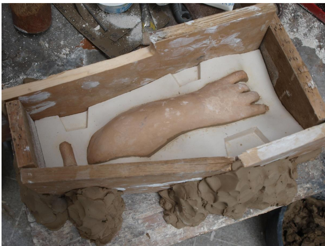
Obrázek 62 – zhotovený první díl sádrové formy před zalitím druhé části
