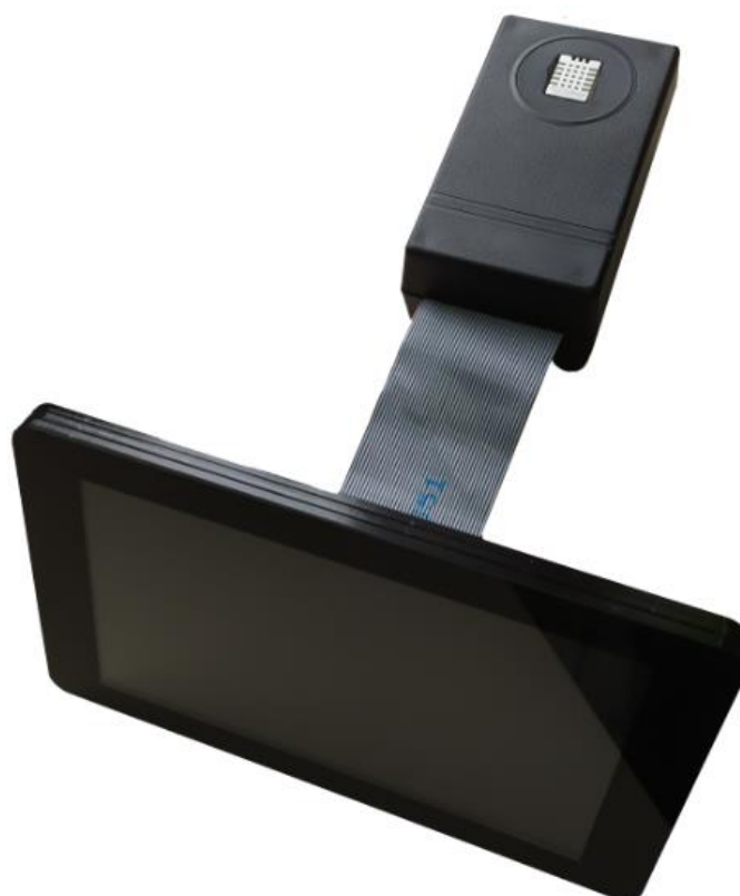
Obr. 15 – Zapouzdření vnitřní části s uzavřeným montážním boxem
