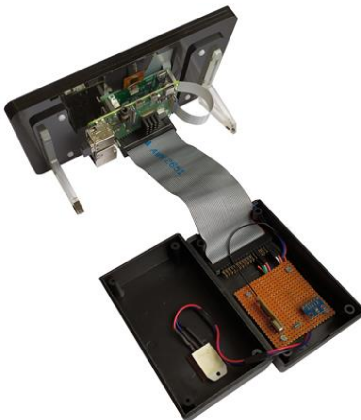
Obr. 14 – Zapouzďení vnitřní části s otevřeným montážním boxem
