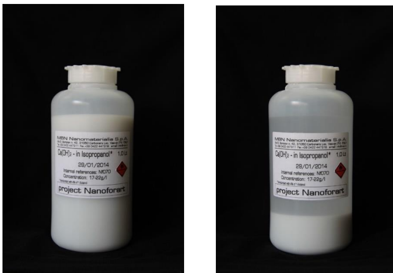
Obr. 4, 5: Neředěná vápenná nanosuspenze MBN Nf070, která svou nestabilitu projevovala již při svém doručení. Vlevo: po promíchání, vpravo: průběh sedimentace \text{Ca}(\text{OH})_2 po 1 týdnu.
