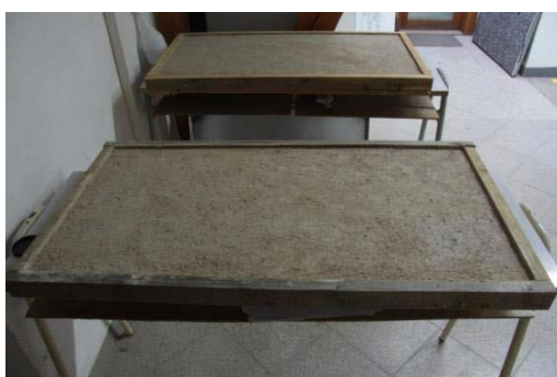
Obr. 10 Průběh přípravy zkušebních panelů, nanесení arriccio
