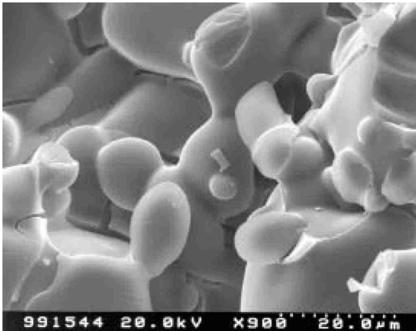
Obr. 6: Skleněná fritra impregnovaná prostředkem KSE 300 E; zřetelně přemostující gelové struktury v prostoru pórů. 34 Elektronová mikroskopie.
