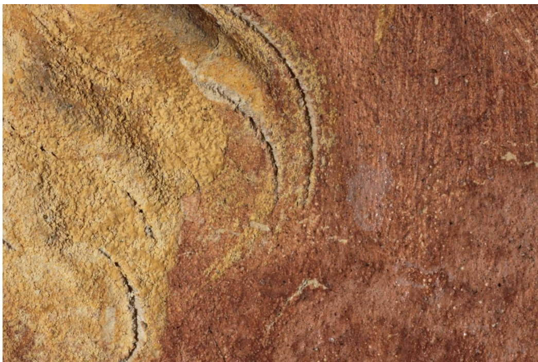
Obr. 30: Detail zpráškovatělé barevné vrstvy na štuku hlavy andílka. Napravo od štuku se nachází lesklé skvrny po fixážním prostředku použitém v letech 2005-2006
