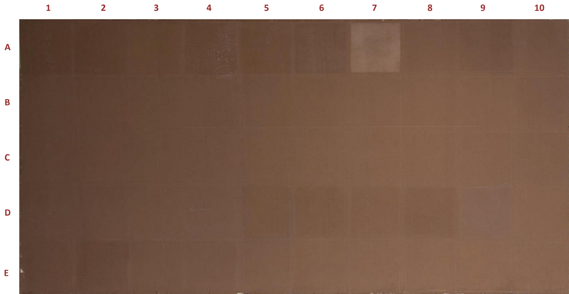
Obr. 16: Testování na zkušebním panelu II, stav po aplikaci všech zpevňujících prostředků
