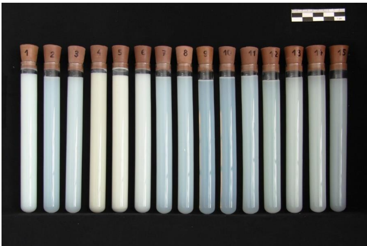
Obr. 8: Zkumavky 1-6 obsahují neředěné vápenné suspenze, v dalších jsou suspenze naředěné na koncentraci 5g/l původním typem alkoholu.
