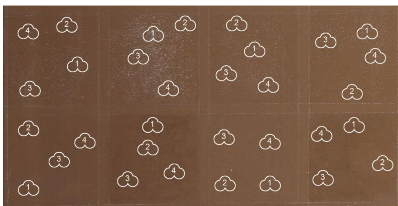
Obr. 18 Ukázka označení míst měření bílého zákalu (body 1-4) spektrofotometrem na zkušebním panelu.
