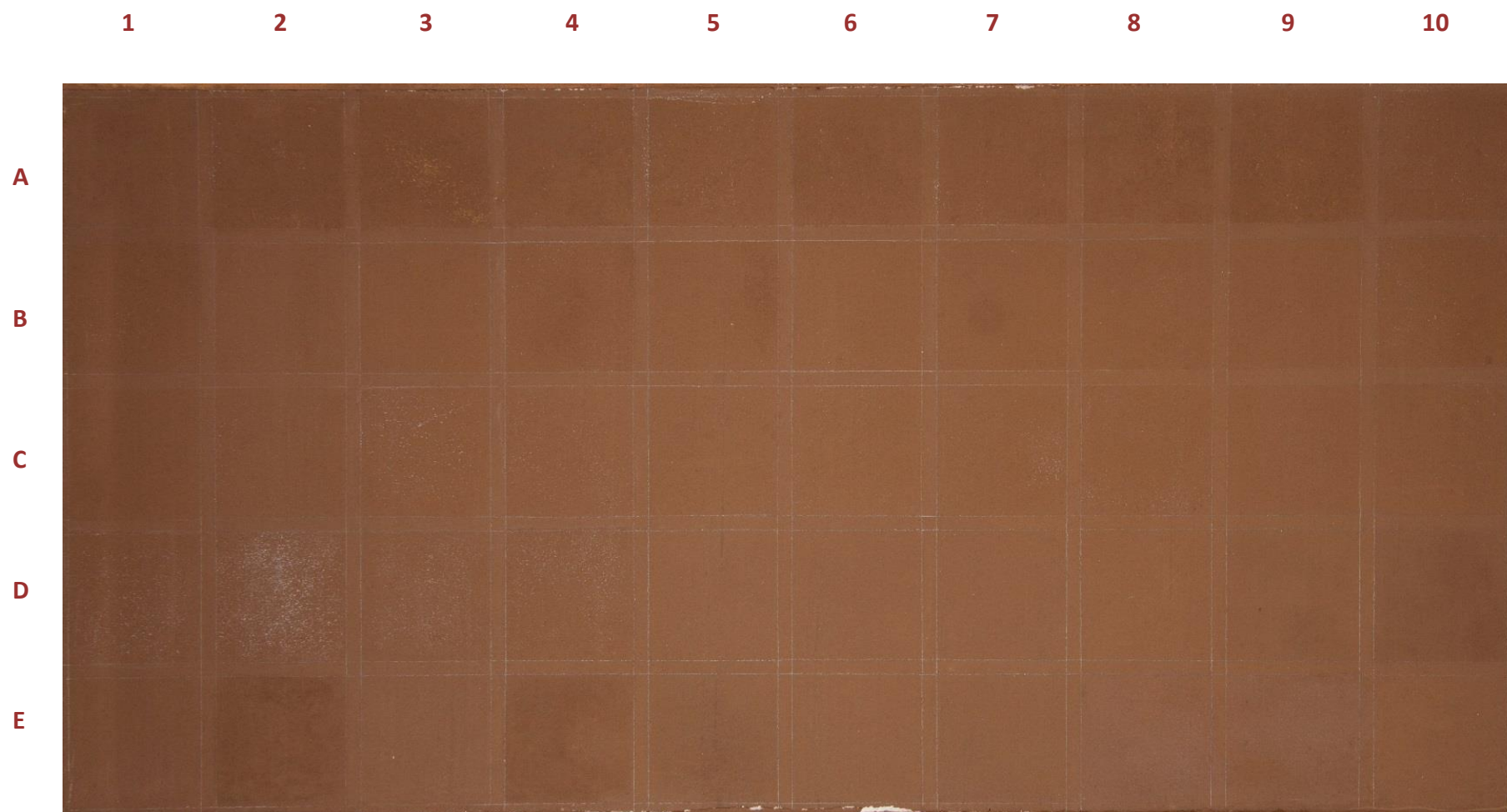
Obr. 13: Testování na zkušebním panelu I, stav po aplikaci všech zpevňujících prostředků
