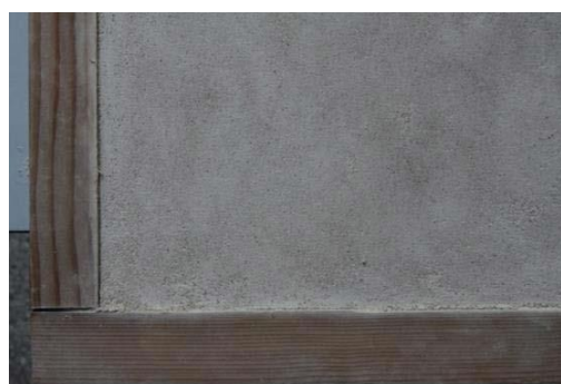
Obr. 11 Průběh přípravy zkušebních panelů, nanесení intonaca s nižším obsahem pojiva
