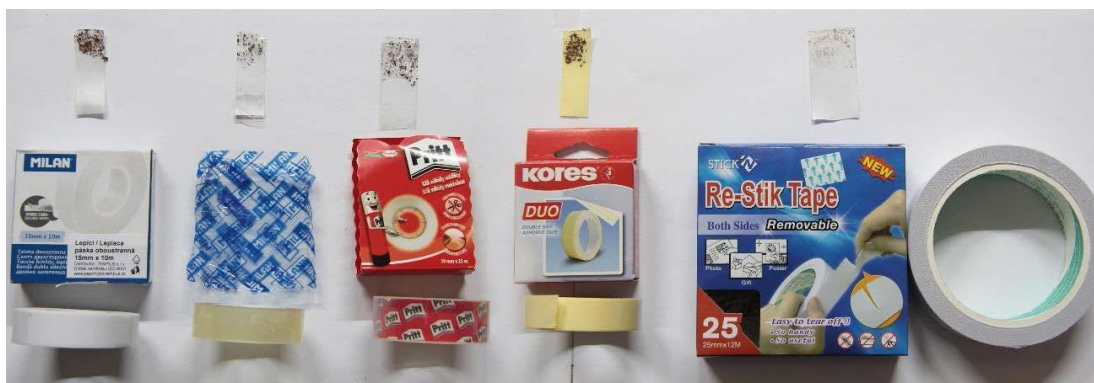
Obr. 23 Testované lepicí pásky s různou lepivostí a velikostí. K odtrhovému testu I byla zvolena třetí páska zleva.
