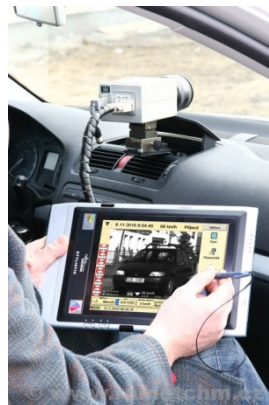
Výstupní obrazovka Ramet 10C v interiéru vozidla
