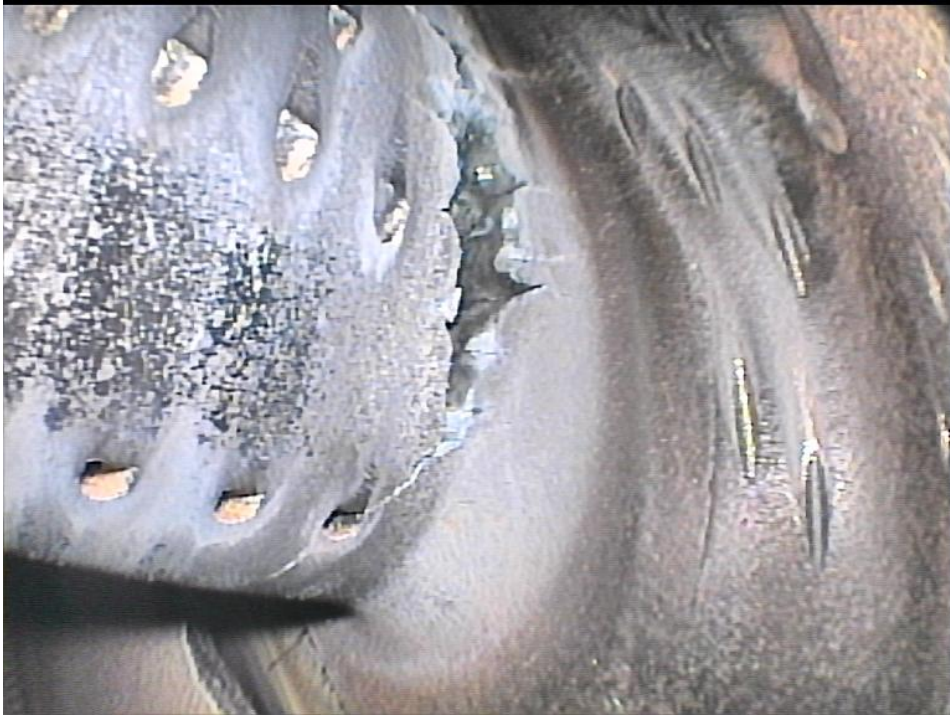
Obrázek 44 Otevřená prasklina na statoru HPT
