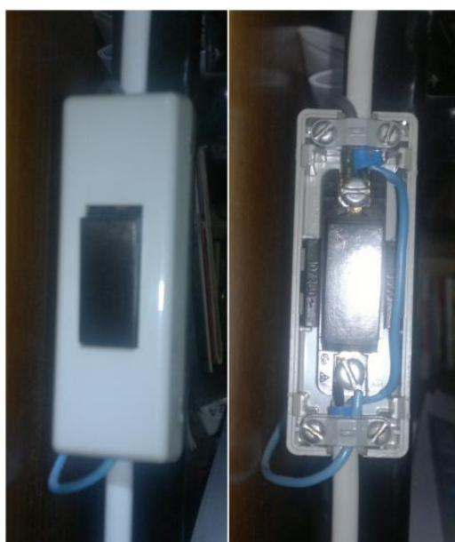
Obrázek 18 - Vypínač bodového osvětlení stolu (zdroj: vlastní)
