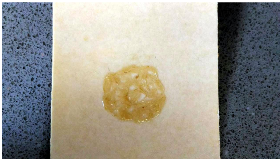
Obrázek 11 - Tkáňový vzorek 100 roupic na oboustranné lepicí pásce připravený k optimalizaci podmínek LIBS analýzy
