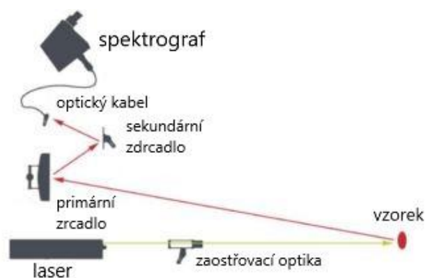
Obrázek 4 - Schéma LIBS analýzy vzorku na větší vzdálenosti. Převzato a modifikováno z [29].
