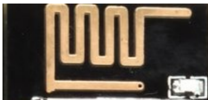
Obrázek 6: Leptaná anténa na kitu ESP8266
