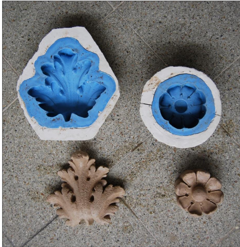
Obr. 68 - Silikonové formy – odlitky s čerstvými odlitky s použitím malty Belite Gussmörtel (Röfix)
