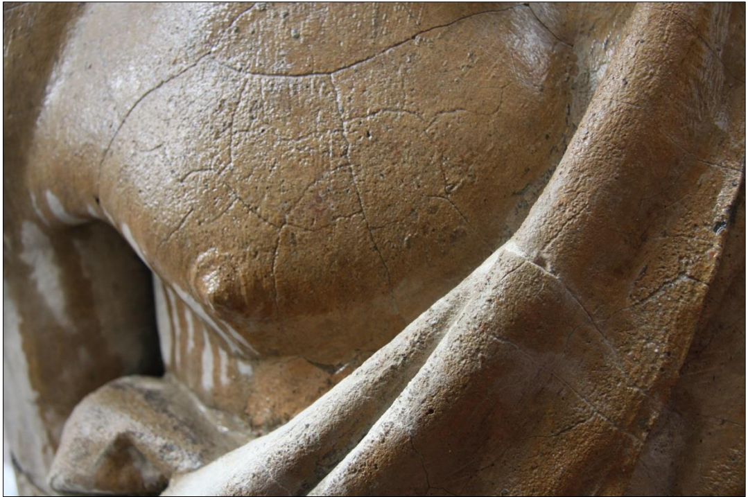
Obr. 27 - Detail hrudi - po očištění plastiky se odkryl povrch s mnoha prasklinami, typickými pro románský cement.
