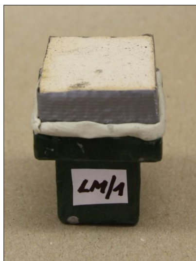
Obr. 71 - Na obrázku vlevo forma pro měření paropropustnosti vodních par historických vzorků, na obrázku vpravo uskladnění vzorků při paropropustnosti vodních par v klima-komoře s konstantní RH.
