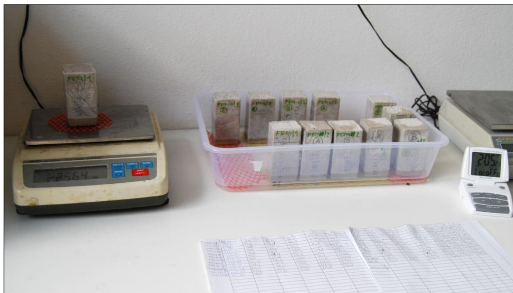
Obr. 70 - Průběh měření koeficientu kapilární absorpce vody.
