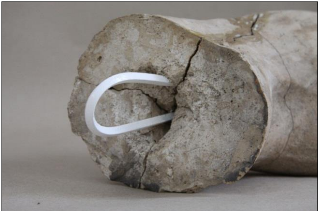
Obr. 29 - Detail levé dlaně plastiky s otáčkoměrem. Injektáž husté sítě prasklin pomocí nízkoviskózního epoxidového lepidla.
