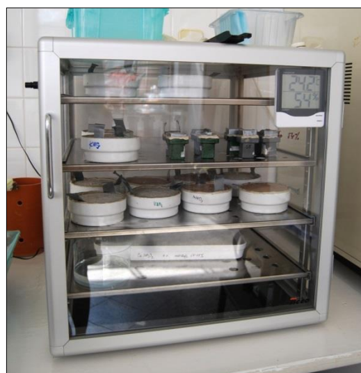
Obr. 71 - Na obrázku vlevo forma pro měření paropropustnosti vodních par historických vzorků, na obrázku vpravo uskladnění vzorků při paropropustnosti vodních par v klima-komoře s konstantní RH.
