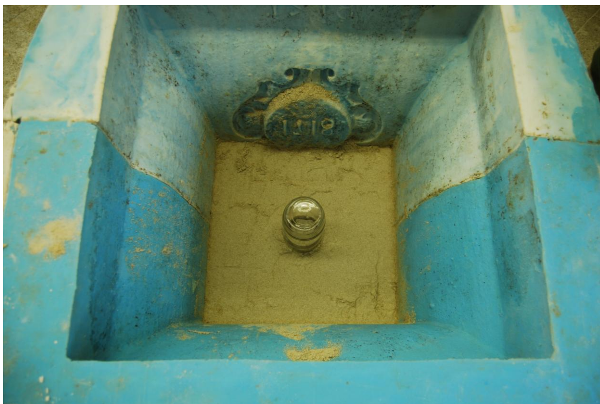
Obr. 42 a 43- Provázaná polovina formy. Zhotovování faksimile na minerálním základě- „dusání“.
