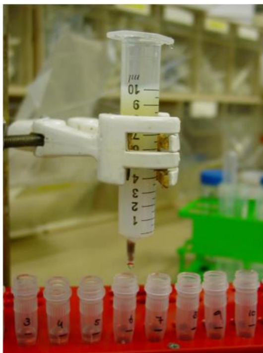
Obrázok 6: Kolóna naplnená sefarózou CL-2B pre izoláciu EVs z ľudskej plazmy [95]
