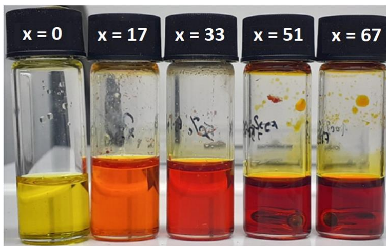
Obrázek 23 – Roztoky skel systému \text{As}_{33}\text{S}_{67-x}\text{Se}_x připravené metodou míchání roztoků.
