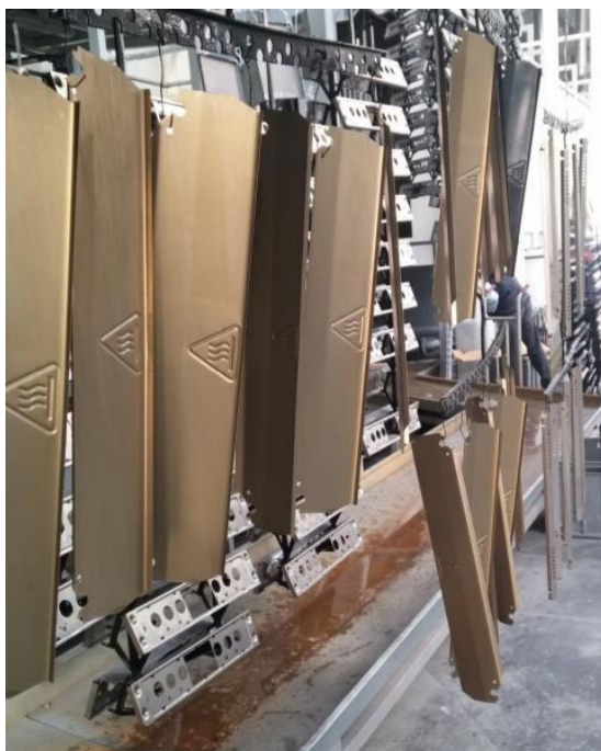
Obr. 4. Typicky zlatavá barva zirkonové pasivace
