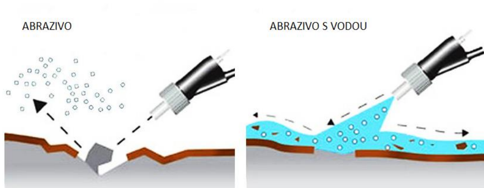
Obr. 2. Rozdíl mezi suchým a mokrým tryskáním [16]
