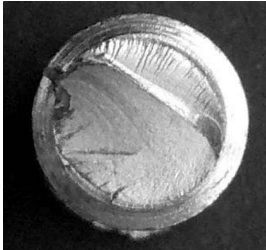
Obr. 2: Únavový lom, zdroj [5]
