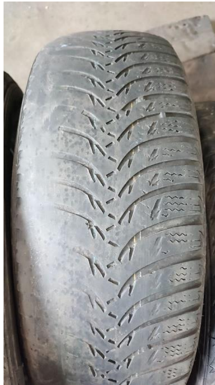
Obr. 5: Nerovnoměrně ojetá pneumatika (vlastní fotografie, 2024)
