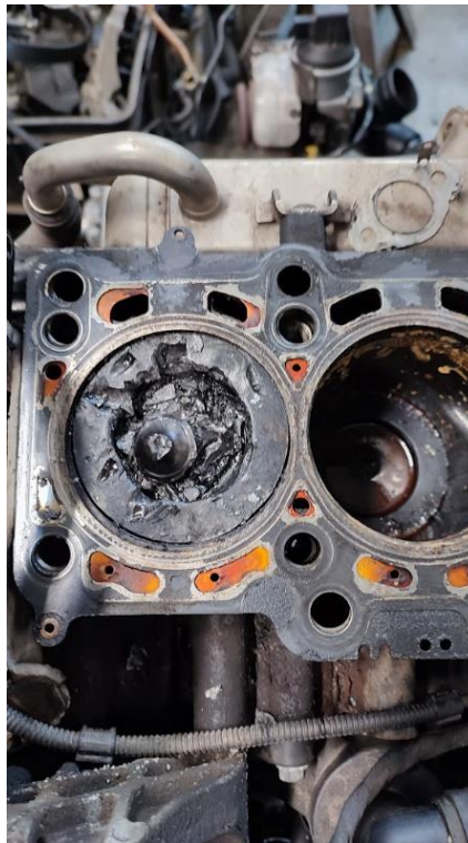
Obr. 7: detail pístu po sundání hlavy motoru Škoda Octavia III. (vlastní fotografie, 2024)
