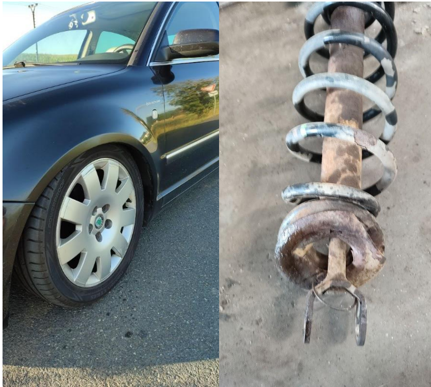
Obr. 6: Podezřelý stav vypružení automobilu Škoda Superb 1. gen., detail poškozené vzpěry tlumiče s pružinou (vlastní fotografie, 2023)
