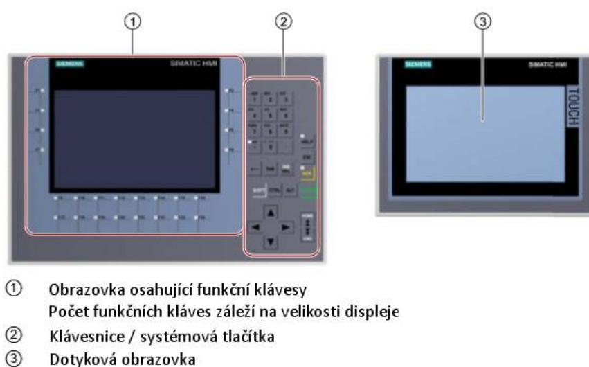
Obr. 2.2 – Simatic HMI varianta s klávesnicí a s dotykový displejem (Siemens AG 04/2012)
