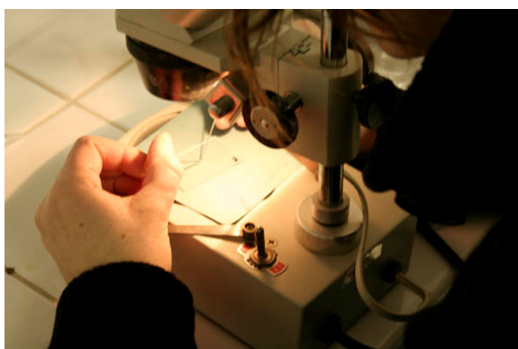
Obr. 33: Rozvlákňování vzorku papíru
