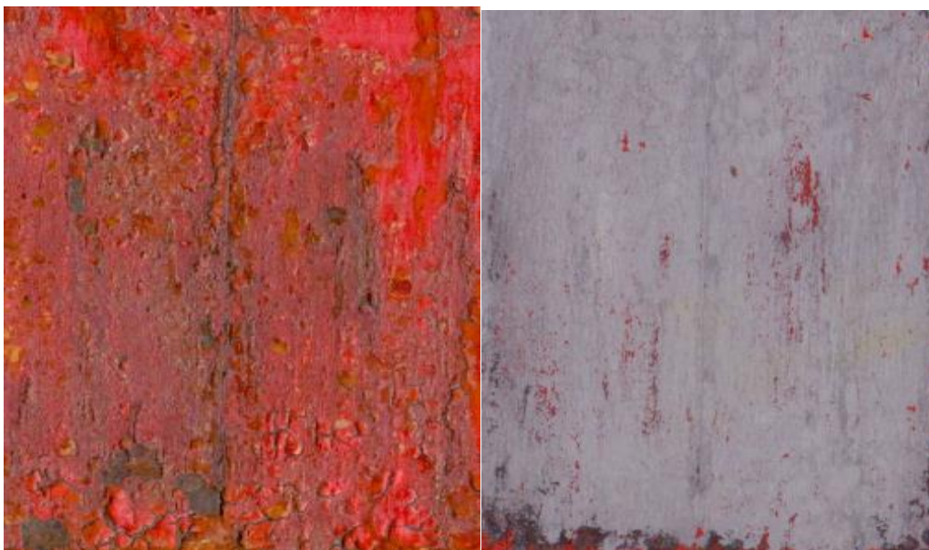
Obrázek 30: Nátěr Versalové červeň po zrychlené korozní cyklické zkoušce
