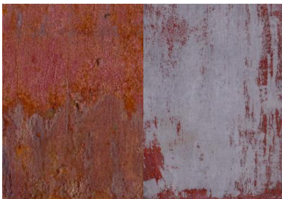
Obrázek 31: Nátěr Fe 2 O 3 červený po zrychlené korozní cyklické zkoušce
