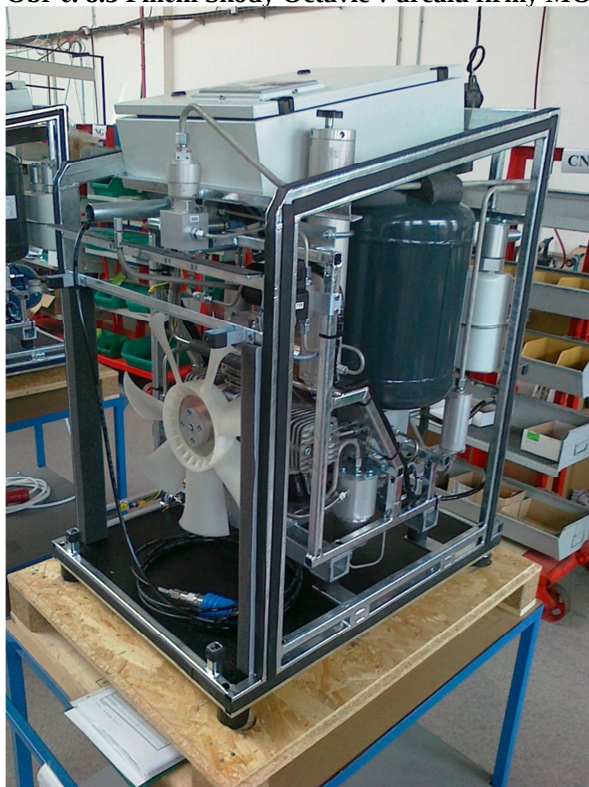
Obr. č. 8.4 Pohled na plnicí zařízení MJ05 bez krytů [12]
