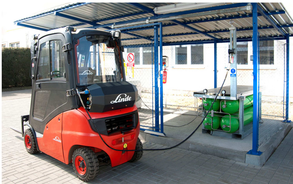
Obr. č. 9.1 Plnění vysokozdvížného vozíku LINDE H20 v areálu firmy MOTOR JIKOV STROJÍRENSKÁ a.s. [12]
