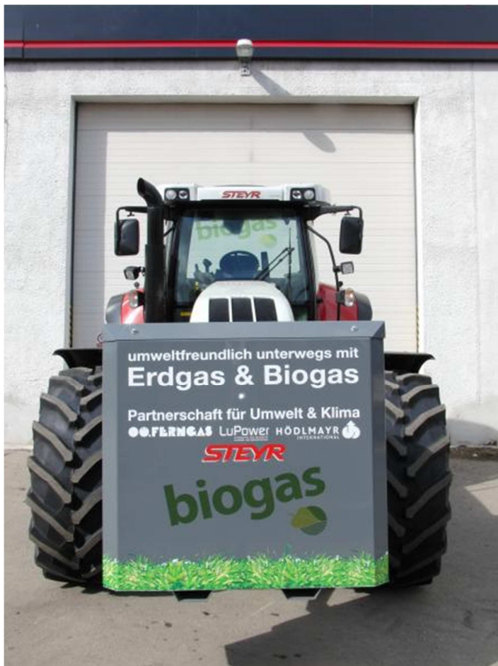
Obr. č. 7.3 Traktor Steyr 6195 CVT s mobilním nosičem CNG tlakových lahví na předním tříbodovém závěsu [8]
