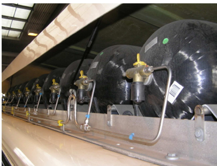
Obr. č. 6.1 Tlakové nádrže CNG autobusu umístěné na střeše vozidla
