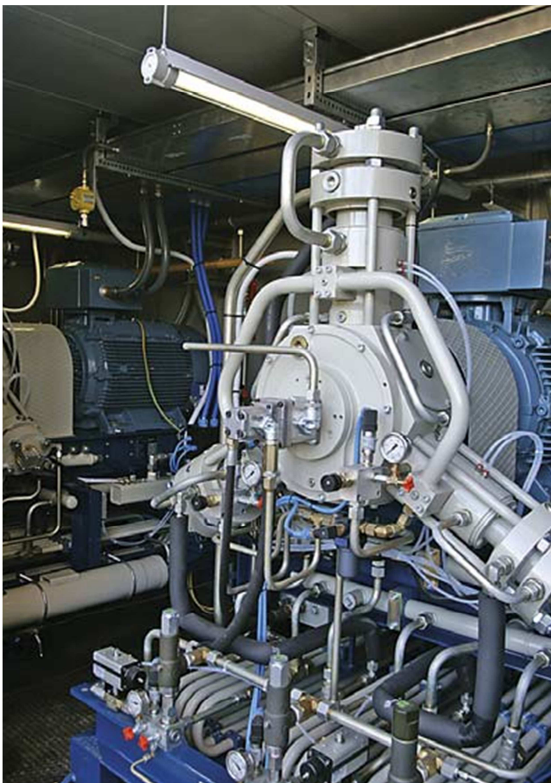
Obr. č. 8.6 Třístupňový kompresor švýcarského výrobce GREENFIELD používaný ve veřejných plnicích stanicích společnosti Gascontrol s.r.o. [10]
