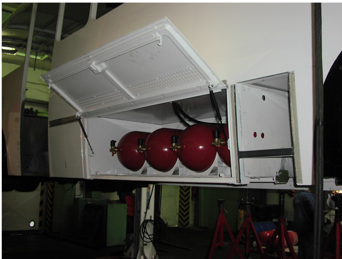
Obr. č. 10.1 Pohled na umístění tlakových nádrží CNG při přestavbě autobusu firmou ZLINER [14]
