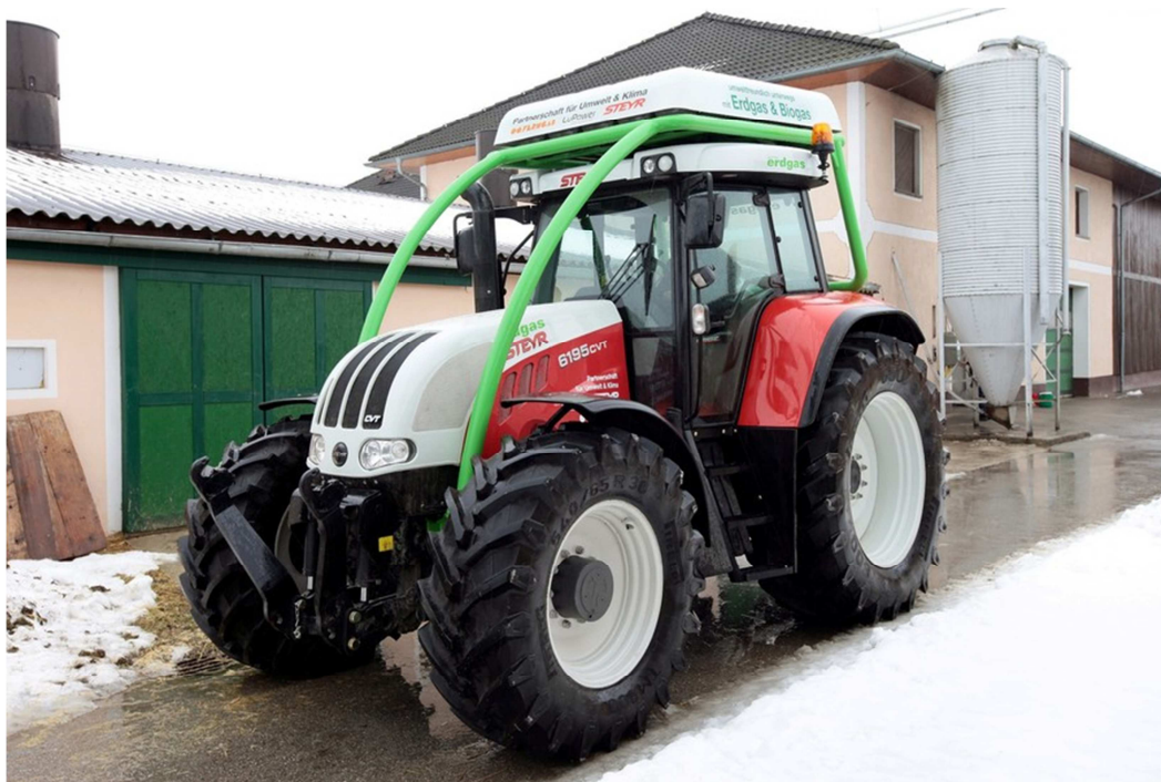
Obr. č. 7.4 Traktor Steyr 6195 CVT se speciální nástavbou nosiče CNG tlakových lahví na střeše
