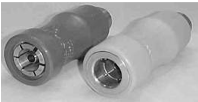
Obr. č. 2.1 Plnicí koncovka NGV1 používaná například pro osobní automobily
