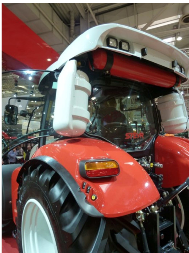
Obr. č. 7.6 Traktor Steyr Profi 4135 Natural Power – částečný pohled na umístění tlakových nádrží CNG [9]
