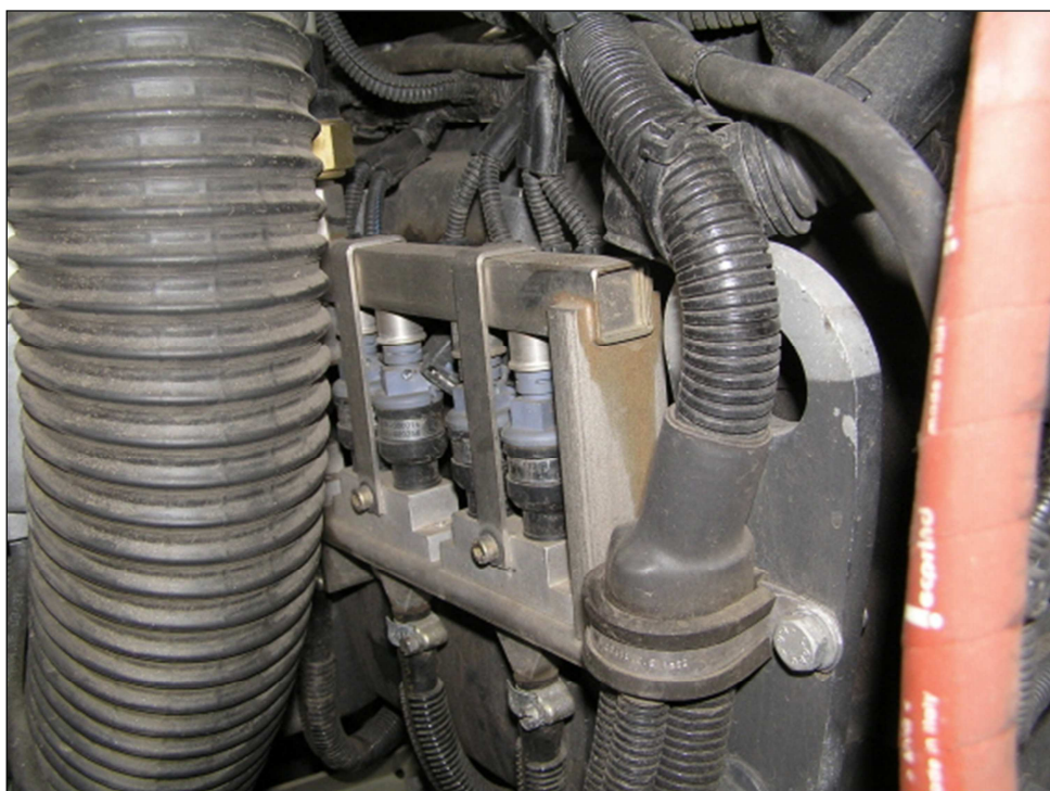
Obr. č. 6.4 Vstříkovací trysky CNG autobusu
