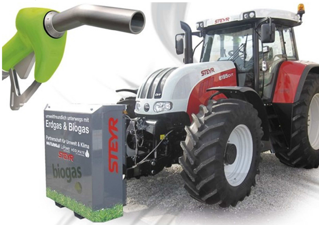
Obr. č. 7.1 Traktor Steyr 6195 CVT s mobilním nosičem CNG tlakových lahví na předním tříbodovém závěsu
