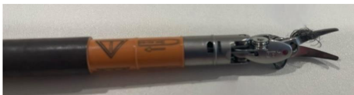
Obrázek 10 Přetrhaná lanka na robotickém nástroji
