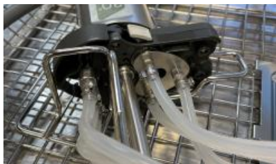
Obrázek 30 Detailní záběr připojení robotické kamery k promývacímu systému
