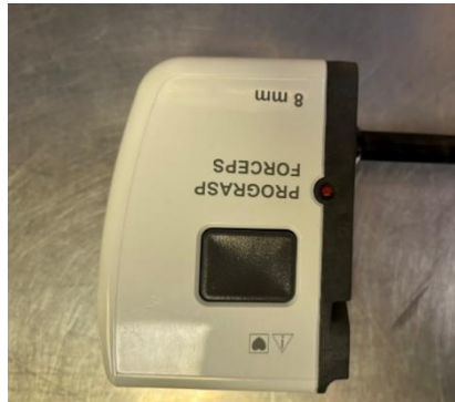
Obrázek 9 Detailní záběr indikátoru životnosti robotického instrumentária
