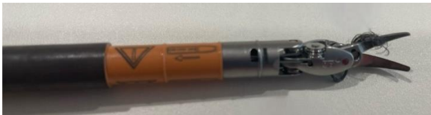
Obrázek 29 Přetrhaná lanka robotického nástroje
