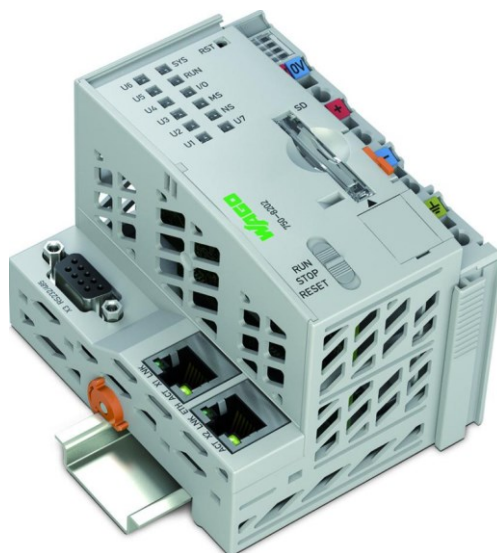
Obrázek 11: PLC WAGO 750-8202 (Procesorový modul PFC200, 2024)
