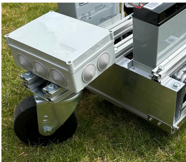
Obrázek 17: Uchycení předního kola manipulátoru (VLASTNÍ, 2025)
