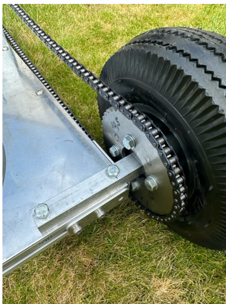
Obrázek 18: Uchycení zadního kola manipulátoru (VLASTNÍ, 2025)
