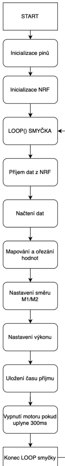
Obrázek 21: Vývojový diagram programu manipulátoru (VLASTNÍ, 2025)
